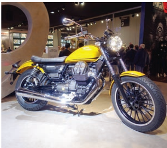
V9 Bopper mit dicken 16-Zoll-Rädern - der Motor leistet 55 PS aus 850 Kubikzentimetern.
