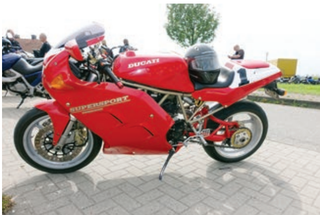
Seltene Ducati Chiara, dieses Sondermodell baute ein Vertragshändler auf Basis der Ducati 900 SS. Zu den Besonderheiten gehört die schöne Gitterrohrschwinge aus Aluminium.
