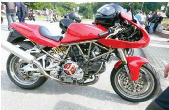
Seltene Ducati Chiara, dieses Sondermodell baute ein Vertragshändler auf Basis der Ducati 900 SS. Zu den Besonderheiten gehört die schöne Gitterrohrschwinge aus Aluminium.
