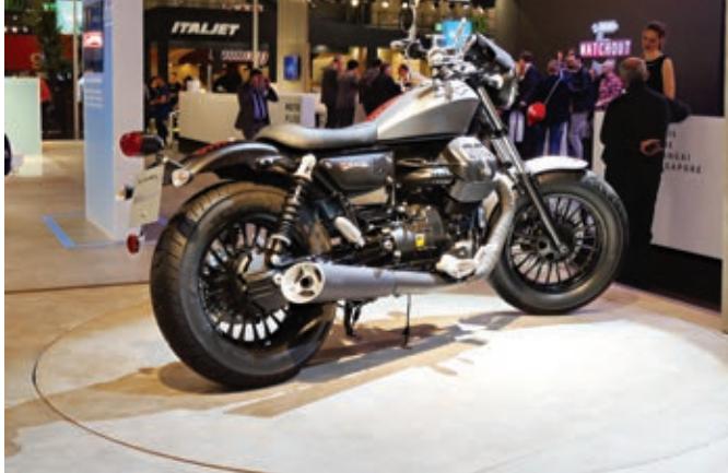
V9 Bopper mit dicken 16-Zoll-Rädern - der Motor leistet 55 PS aus 850 Kubikzentimetern.
