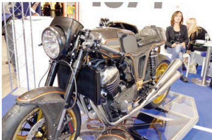
Segoni G800 Oro als unverkleideter Sportler mit vergoldetem Zentralrohr-rahmen und sehr viel Carbon.
