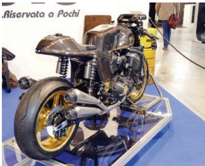
In den Siebzigern waren Vier-in-eins-Auspuffanlagen Pflicht für sportliche Bikes. Diese Segoni hat aber vier Auspuffrohre.
