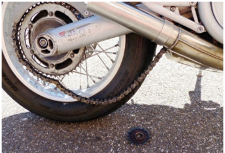
Während der Fahrt ist das Ritzel verloren gegangen.
