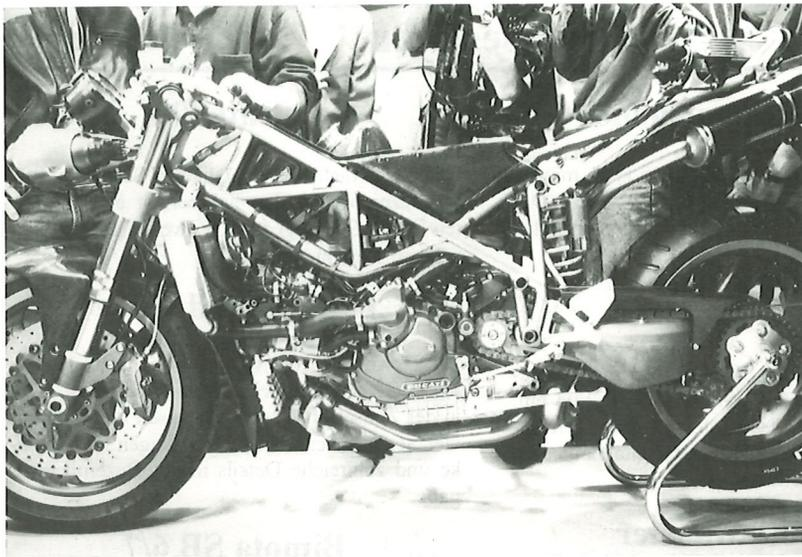
fern versehen. Um den Zugang zum Motor zu erleichtern, ist die Verkleidung teilweise mit Schnellverschlüssen versehen. Auch der Tank erinnert etwas an die Supermono, während die Sitzbank neu gestylt wurde.
