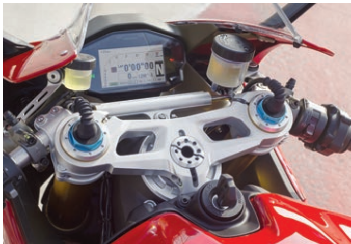
Sowohl die Gabel als auch der Lenkungsdämpfer sind elektronisch einstellbar.
