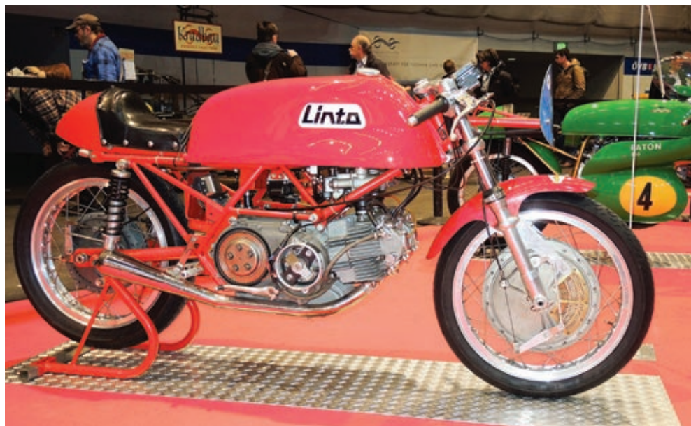
Die Bezeichnung Linto stand für Lino Tonti, der für dieses Motorrad zwei Aermacchi-Motoren miteinander koppelte.
