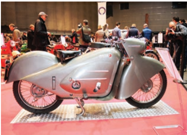
Miller Balsamo 200 mit selbsttragender Blechkarosserie.
