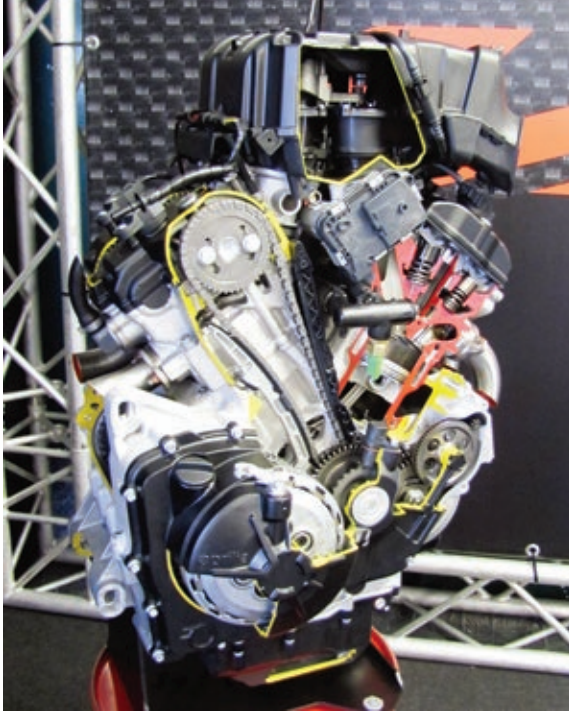
Der V4-Motor ist extrem kompakt. Die Zylinder befinden sich in der oberen Gehäusehälfte.
