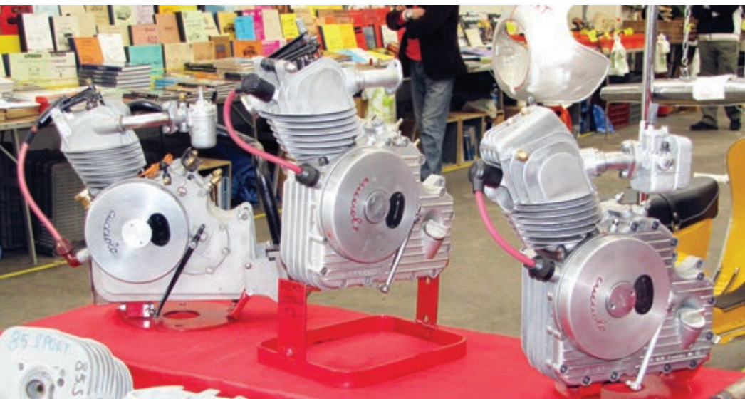
Der Cucciolo-Motor bedeutete für Ducati den Einstieg in die Zweiradwelt. Im Laufe der Jahre entstanden drei unterschiedliche Versionen mit offenem und geschlossenem Ventiltrieb - von links nach rechts T1, T2 und T3.
