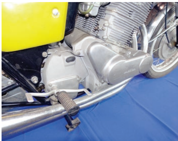
Schaltwippe auf der rechten Seite. Hinter dem rechten Zylinder sitzt der Anlasser, der per Kette die Kurbelwelle in Rotation versetzt.
