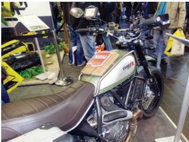
Tankschutzbügel für die Scrambler mit integriertem „Frühstücksbrett“.
