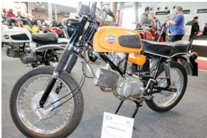
Laverda 125 Trial von 1965. Der Viertaktmotor mit liegendem Zylinder leistet 10,5 PS bei 9.000 U/min. Für das Ausland gab es auch eine 150er-Variante.
