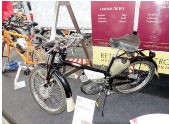
Unten: Laverda Mofa von 1964. Das besondere an der Laverdino sind die mechanischen Scheibenbremsen vorne und hinten.
