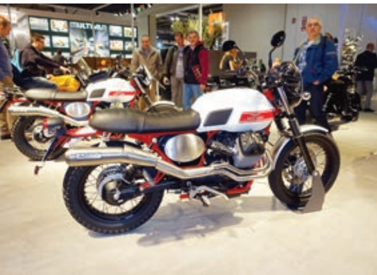
Bei der limitierten V7 II Stornello Scrambler ist lediglich der Rahmen rot hervorgehoben. Gabel, Schwinge, Endantrieb und Felgenringe sind schwarz lackiert. Die hochgezogene Auspuffanlage stammt von Arrow.
