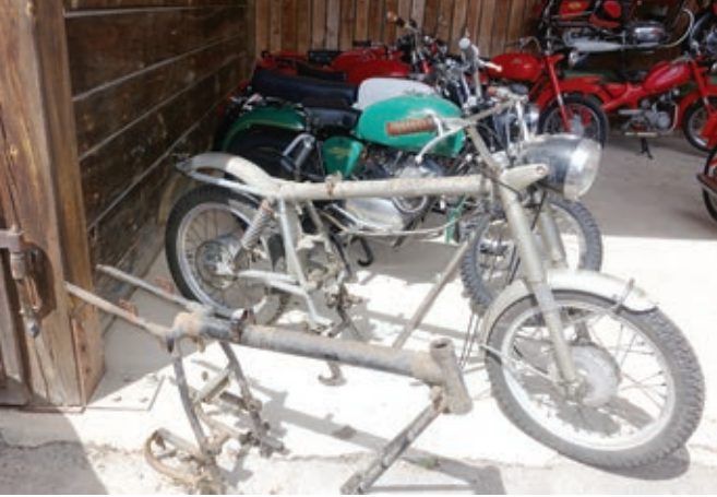
Der Rahmen bestand aus geraden Rohren, auch das Fahrwerk war einfach aufgebaut.
