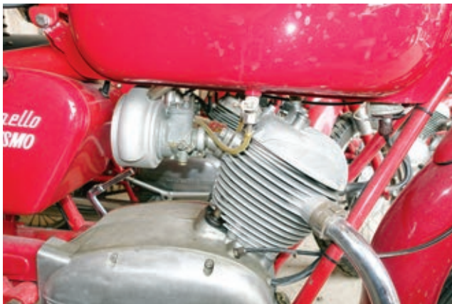
Bei der Stornello 125 (Turismo) sitzt der Vergaser (Dell'Orto MD 18 BS) mittig hinter dem Zylinderkopf.
