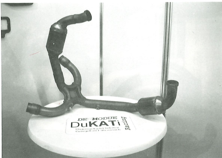
Krümmeranlage von DSM mit zwei unregelmäßig geformten Katalysatoren für Zweiventil-Ducatis.
