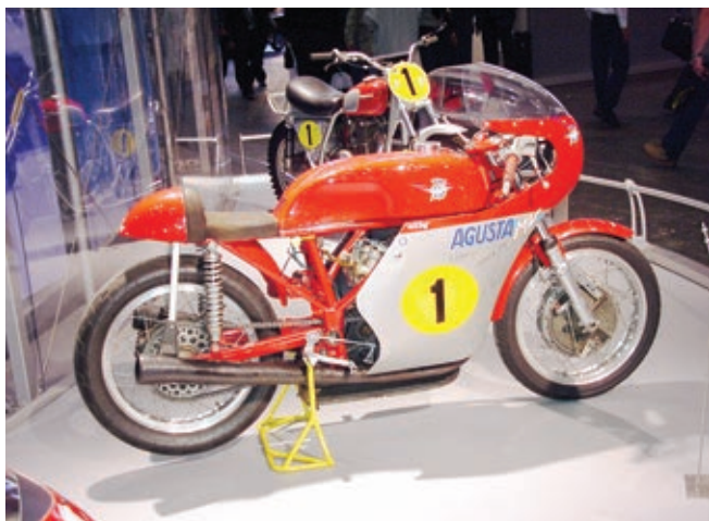
Zwei Megaphone links und eins rechts, die Konkurrenz bekam die Auspuffanlage dieser überaus erfolgreichen Rennmaschine meist nur von hinten zu sehen.
