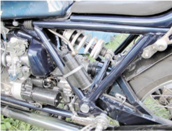
Guzzi mit nur einem Stoßdämpfer, das nennt man Zentralfederung in Cantileverbauweise. Die Aluminiumschwinge war ein Prototyp von Moto Spezial.
