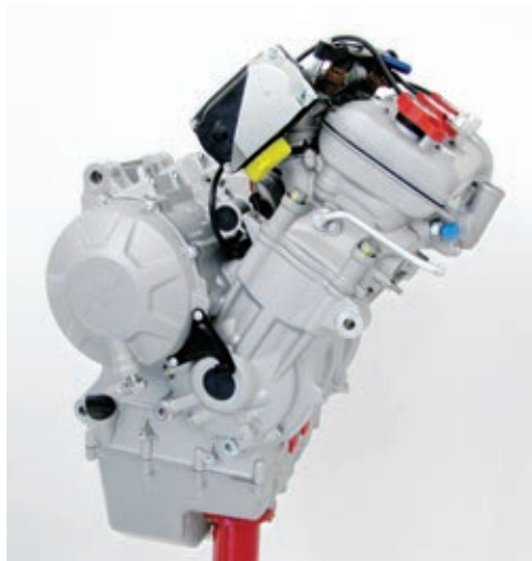
Der Dreizylindermotor mit übereinanderliegenden Getriebewellen baut sehr kurz und hat eine tiefe Ölwanne.
