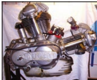
Ducati 750 SS Motor, revidiert, Doppelzündung, Ölkühler, Postanschrift: Hans Willi Nolden, 53572 Unkel, Am Graben 30
