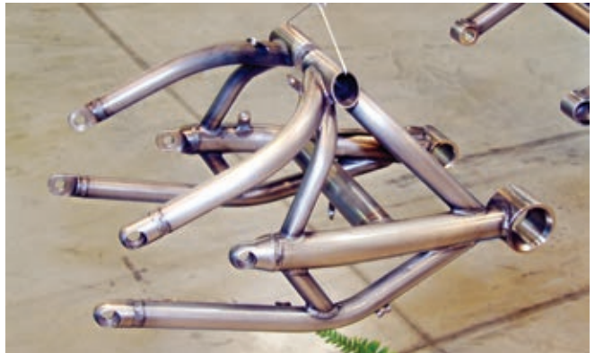
Aus etwa dreißig Teilen wird die Schwinge zusammenschweißt.
