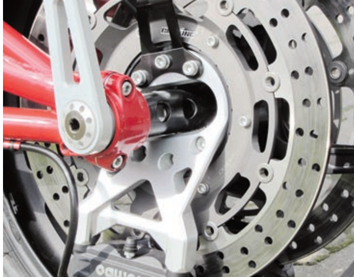
Das Vorderrad schwenkt auf der starren Radachse.
