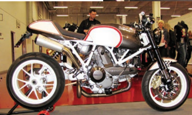
Rechts: Roadster auf Basis des Tonti-Rahmens mit vielen Eigenbauteilen von Guzzi-Spezial. Die beschichtete Edelstahl-Auspuffanlage wird für ungefähr 1.000 Euro angeboten.
