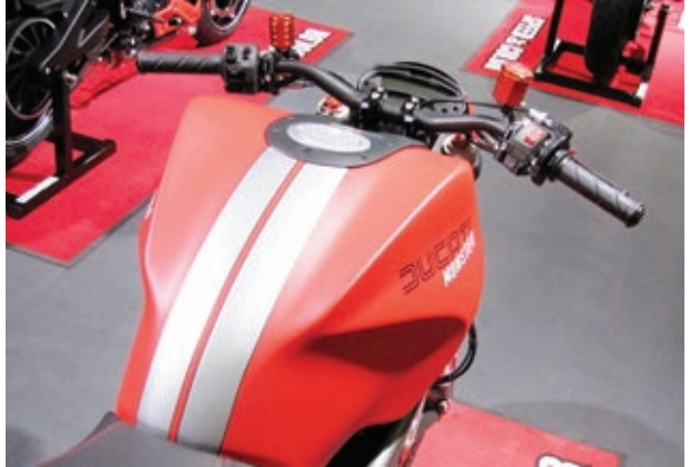
Einteilige Tankabdeckung für die Ducati Monster von Speed of Color aus GFK mit anderer Linienführung.
