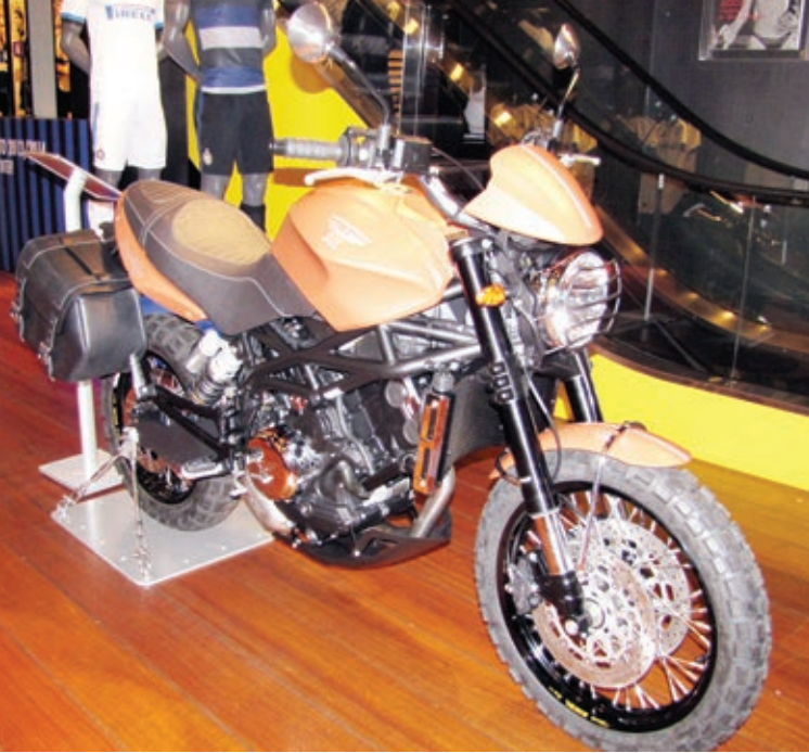
Die Scrambler rollt auf Schlauchlosfelgen, bei der Bereifung hat man die Wahl zwischen normalen Reifen oder Stollengummis.
