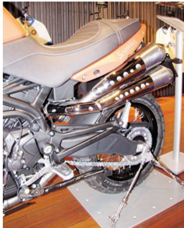
Die Scrambler rollt auf Schlauchlosfelgen, bei der Bereifung hat man die Wahl zwischen normalen Reifen oder Stollengummis.
