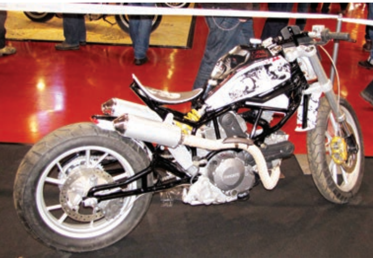
Oben: Bei dieser Ducati wurden Rahmen und Schwinge extra angefertigt.
