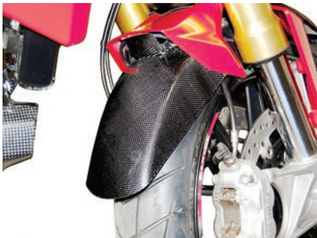
Effektive Verlängerung für den Vorderradkotflügel aus Carbon - schützt den Kühler und andere Teile vor vom Vorderrad aufgewirbeltem Dreck.
