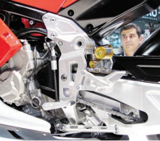
Rahmenseitenteile, Fußrastenanlage, Schalthebel, Seitenständer - alles aus dem Vollen gefräst. Der Schwingendrehpunkt ist höhenverstellbar.
