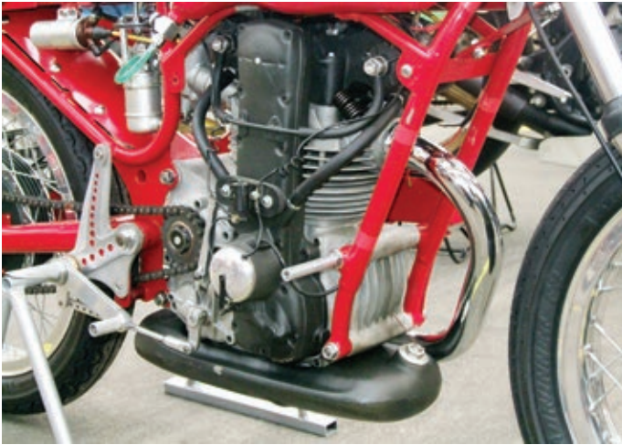
Bei der Umstellung von Trockensumpf- auf Naßschmierung wurde einfach ein großes Ölreservoir unten an den Motor angeflanscht.
