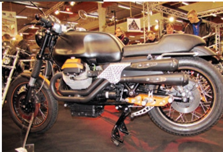
Ducati Sport Classic mit Einarmschwinge, schlankem Solo-Höcker und nur einem Schalldämpfer. Die Auspuffanlage mit speziell angefertigten Krümmern und BOS-Schalldämpfer ist nur halb so schwer wie das Original und kostet bei Bernd Lohrig 1.499 Euro.
