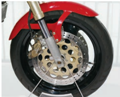
Bremsanlage von der 900 SS aber nur die nicht verstell- bare Gabel der 750 SS.
