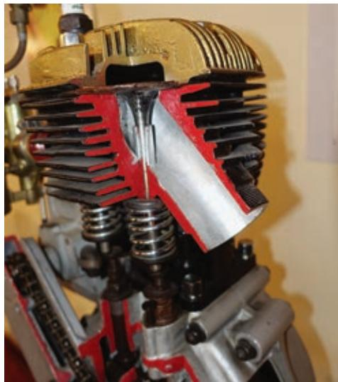
*Hängende Ventile waren typisch für die Motoren von Frera.*
