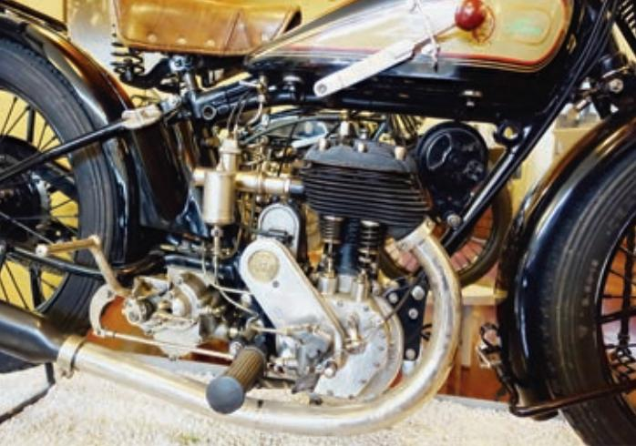
**Frera Turismo 500 von 1928: Motor mit seitengesteuerten Ventilen und das handgeschaltete Getriebe sind voneinander getrennt. Der Rahmen weist Verschraubungspunkte für einen Beiwagen auf.**
