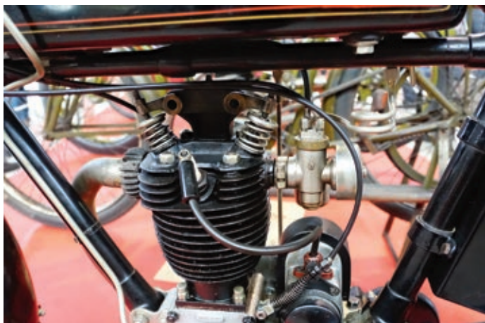
Ventiltrieb mit zylindrischen Druckfedern und Kipphebeln, bei denen die Einstellschrauben oberhalb der Ventile sitzen.
