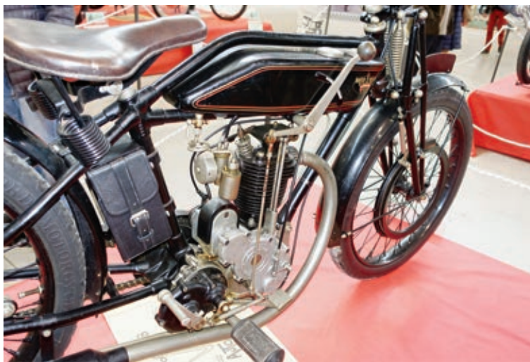
Handschaltung auf der rechten Seite. In den Benzintank war gleichzeitig der Öltank integriert.
