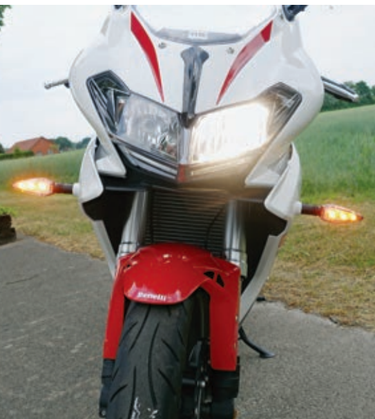
Blinker mit LED-Licht. Beim Abblendlicht leuchtet der linke Scheinwerfer, beim Fernlicht kommt der rechte dazu.
