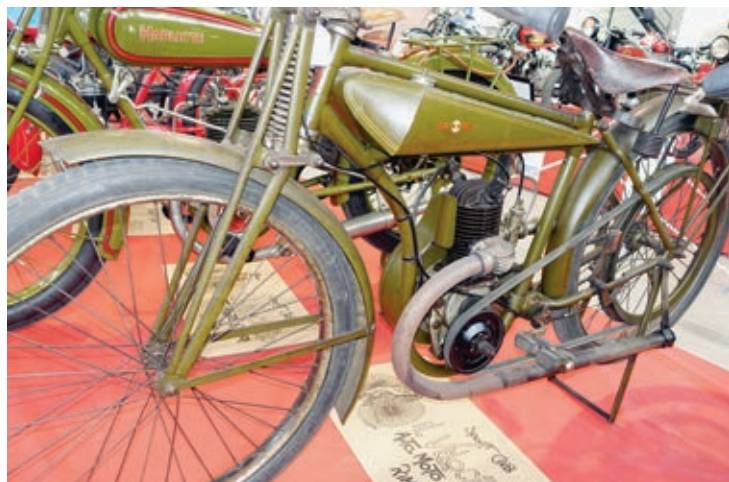
Bei der Gardini sind Kurbelwelle und Hinterrad direkt mit einem Keilriemen verbunden. Die große Riemenscheibe dient gleichzeitig als Hinterradbremse.
