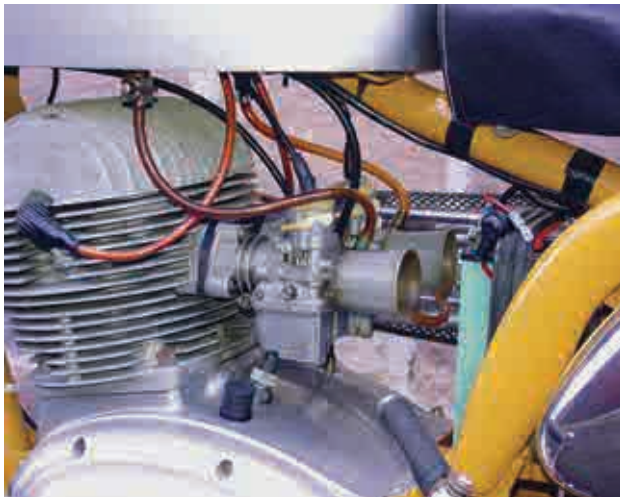
Auf der MV Agusta wurden nachträglich modernere Vergaser mit offenen Trichtern montiert.
