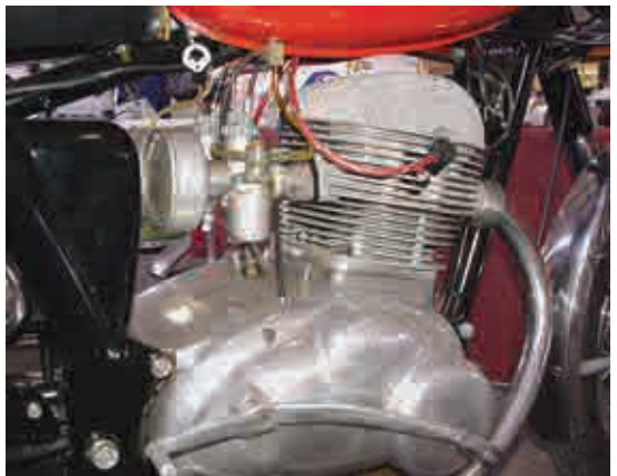
Diese Vergaser mit den Blechlufffiltern gehören original auf die MV Agusta 350 Scrambler.
