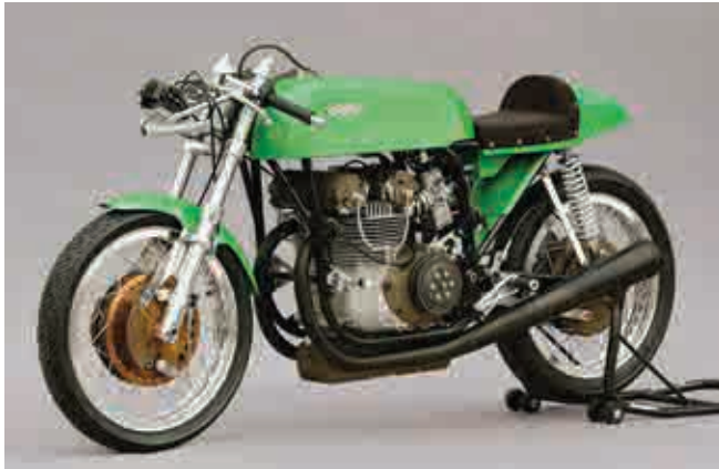
Die Replica der Paton-Rennmaschine in der Version mit vier Ventilen pro Zylinder.
