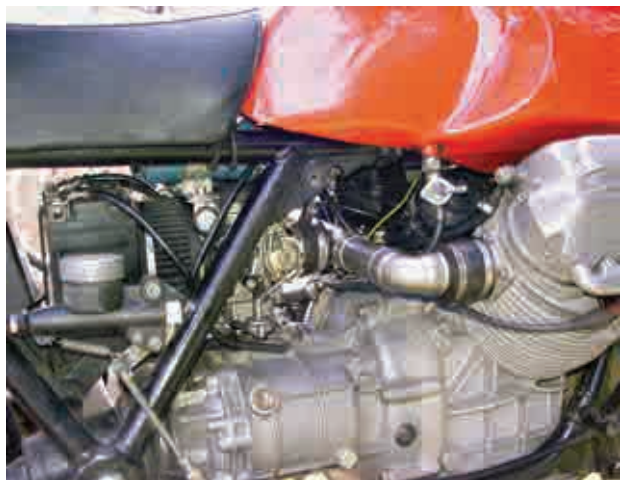
Umbau einer britischen Guzzi auf einen zentralen Vergaser - nie wieder synchronisieren.
