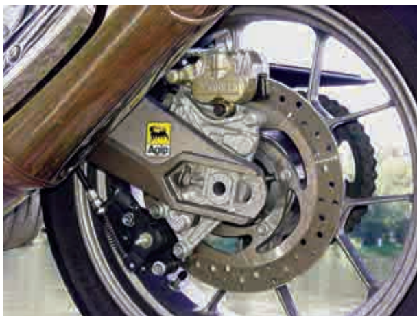
Der schwarze Bremssattel gehört zur Feststellbremse.
