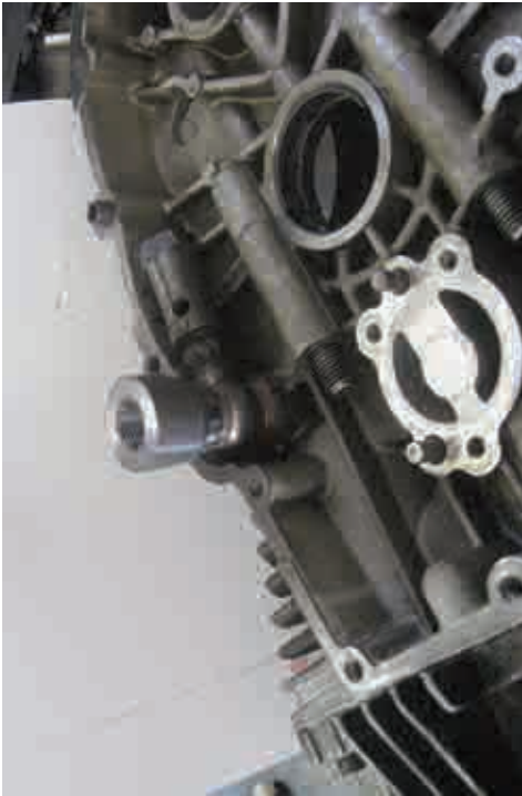
Innerer Adapter für die Ölrückführung mit Ölüberdruckventil.
