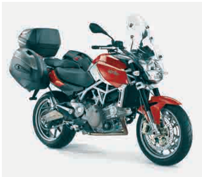
Aprilia plant ein reichhaltiges Zubehörprogramm für die Mana. Anscheinend müssen die Koffer wegen des Auspuffs ungünstigerweise sehr hoch montiert werden.
