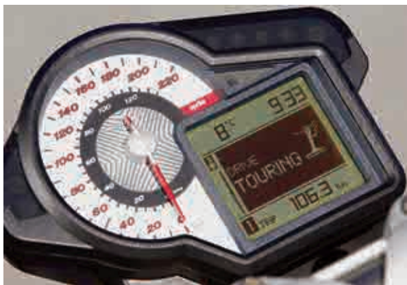
Das Display zeigt den Modus des Automatik-Getriebes an. Außerdem weist es auf den ausgeklappten Seitenständer hin.
