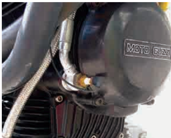
Der Anschluß der Ölrückführung. Eingeschraubt in den inneren Adapter. Hier mit zusätzlichem Öltemperaturgeber.
