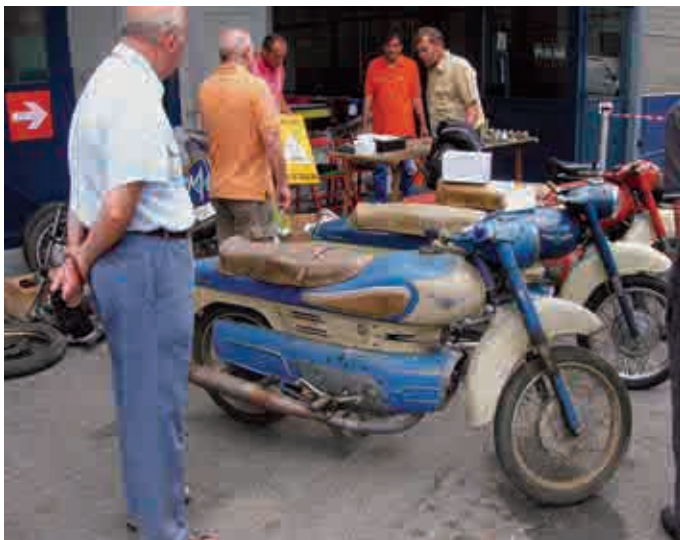
Auch so etwas hat Aermacchi mal gebaut. Unter dem Blechkleid der Chimera verbirgt sich ein fortschrittlicher Zentralrohrrahmen mit Cantileverfederung.
