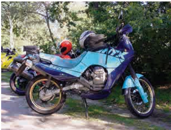
Moto Guzzi NTX mit dem Einspritz-Motor der Brevia 750.
