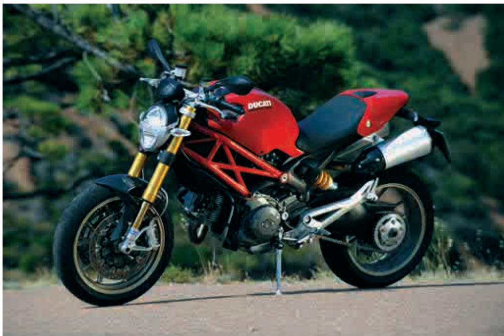
Die M 1100 S verfügt über Feder Elemente von Öhlins und ein paar Carbonteile.
