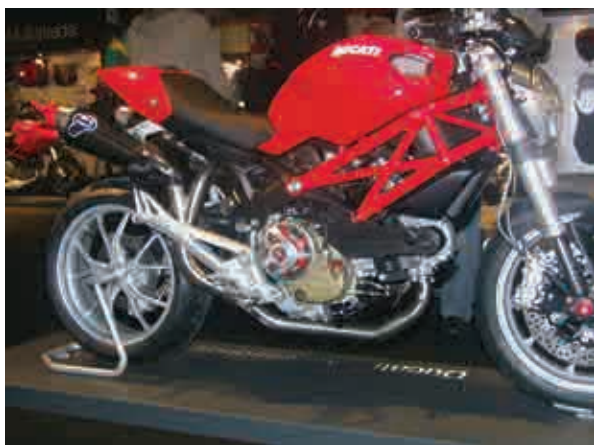
Zubehör gibt es auch schon: hier eine schöne Auspuffanlage mit untenliegendem Krümmer, sauberer Verarbeitung und ohne Drosselklappe.
