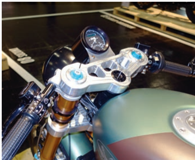
Bei den Radical Guzzis befindet sich die programmierbare Steuerung für die Einspritzanlage im Kombiinstrument.
