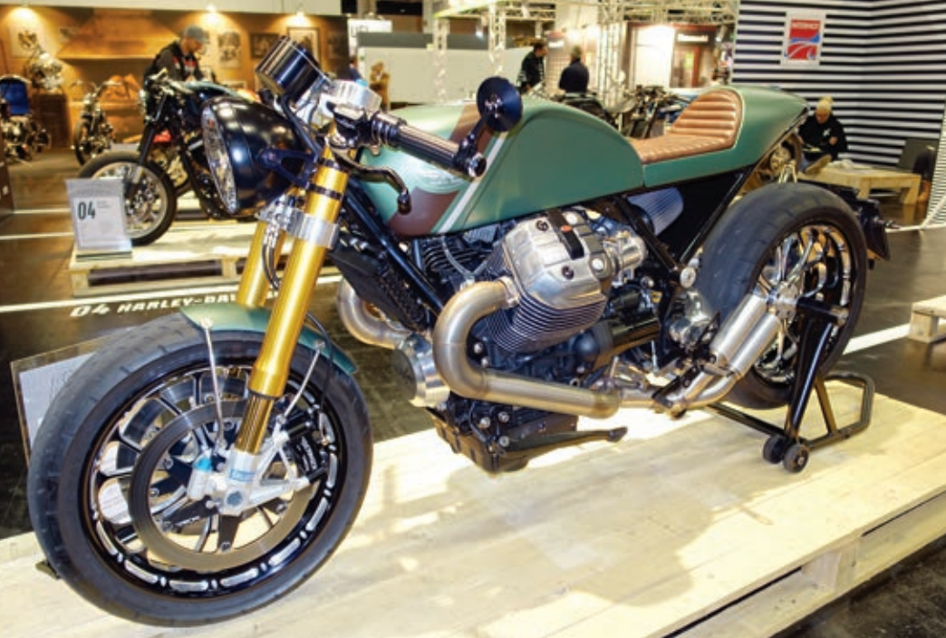
Schlanke Linie - fette Zylinder - handgedengelter Aluminiumtank und knappes Heck.
