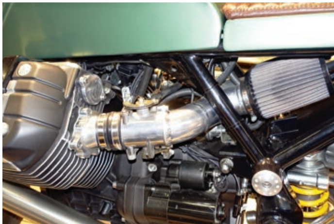
So ein großer Guzzi-Motor muß ordentlich durchatmen dürfen - gefräste Ansaug-stutzen und polierte Saugrohre.
