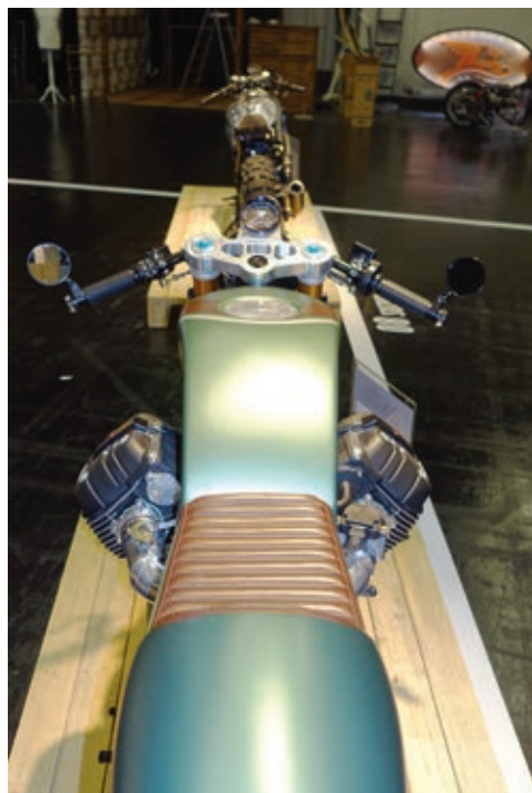
Schlanke Linie - fette Zylinder - handgedengelter Aluminiumtank und knappes Heck.
