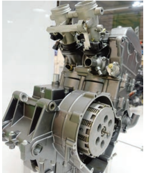
Hinter Glas zeigte Benelli diesen Zweizylinder-Motor mit 754 Kubikzentimetern.
