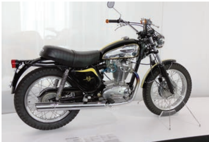
Unten: Die größten Einzylinder-Motoren verfügten über knapp 450 Kubikzentimeter, wie in dieser Scrambler.
