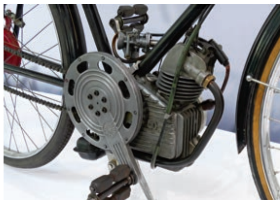
Ein kleiner Hilfsmotor namens Cucciolo mit offenem Ventiltrieb mobilisierte nach dem Krieg die Massen.
