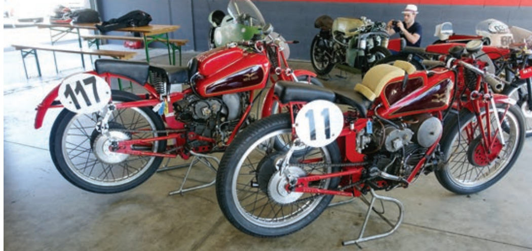
Zwei Kompressor-Varianten der 250er. Die Nummer 11 von 1939 mit Vergaser und die Nummer 117 von 1940 mit Einspritzung.
