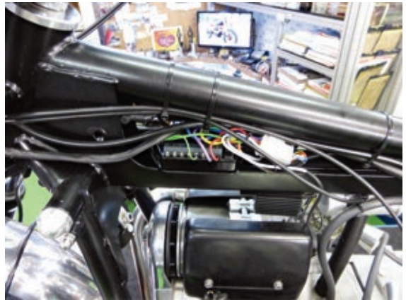
Die Elektrik versteckt sich recht kompakt zwischen den Rahmenrohren.
