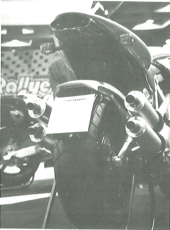
*Vier Schalldämpfer lassen Erinnerungen an vergangene Zeiten wach werden. Zwischen den Auspuffanlagen der einzelnen Zylinder besteht keine Verbindung.*
