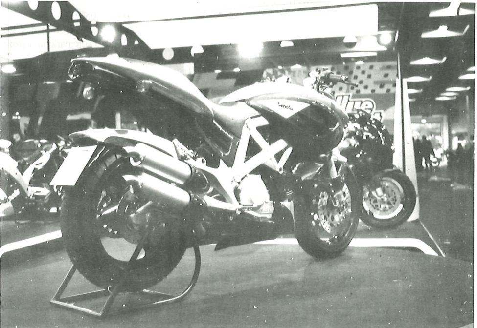
*Durch das lange Innenschutzblech mit Kennzeichenhalterung wurde ein hochgezogenes, 'freischwebendes' Heck möglich.*
