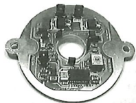
Marelli-Zündmodul ohne Blackbox aber mit LED's, Schalter und Sicherung
