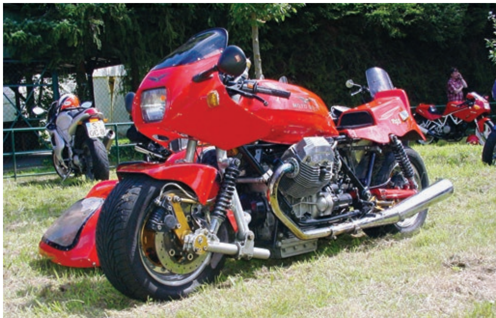
Das ganze Gespann ist extrem niedrig gebaut. Unter der Ölwanne ist nur wenig Platz.
