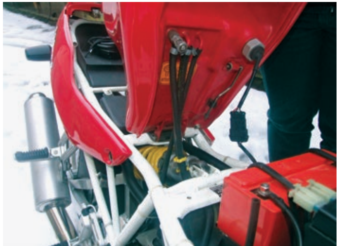
Dieser Tank einer Ducati 900 SS verfügt unten rechts über eine Ablaßschraube.
