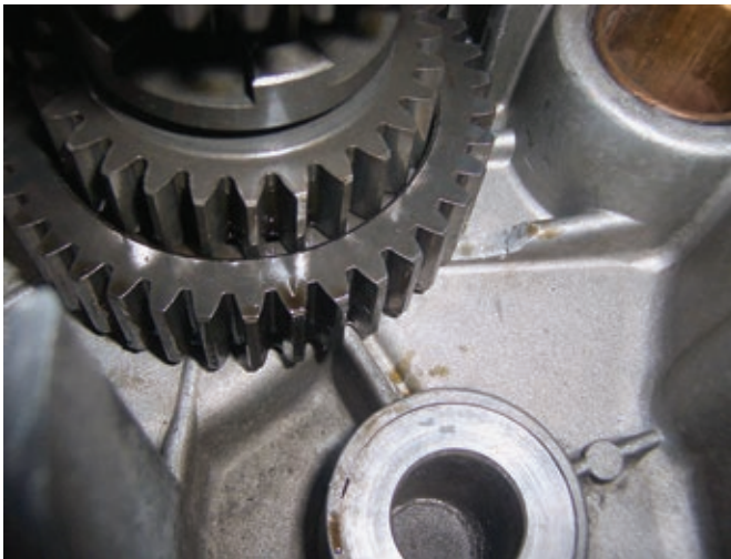
Nach den Fräsarbeiten passen auch die breiteren Zahnräder in das Gehäuse.
