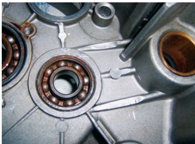
Weil das neue Getriebe etwas breiter baut, müssen ein paar der Verstärkungsrippen im Inneren des Motorgehäuses abgefräst werden.
