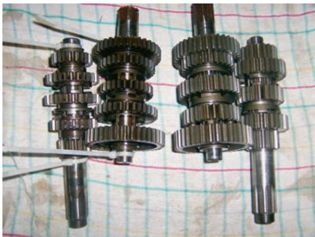
Die beiden Getriebe im direkten Vergleich. Die breiteren, stabileren Zahnräder rechts sind deutlich zu erkennen.
