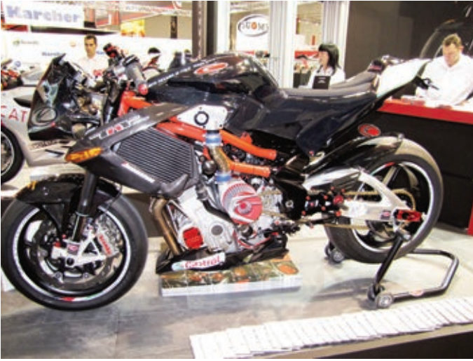
Ambitionierter Umbau der Firma Evotech. Benelli Tornado mit Kompressor und Drehmoment im Überfluß.
