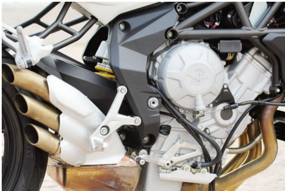
Drei Auspuffrohre weisen auf die drei Zylinder hin. MV Agusta nennt das Trepistoni. Der Motor mit hoch positionierter Kupplung baut sehr kompakt.
