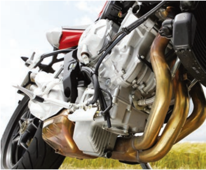
Die Ölwanne beschränkt sich auf die rechte Seite, um der Auspuffanlage Platz zu machen.
