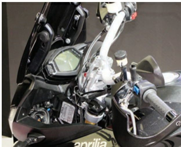
Das Windschild kann mittels Handschrauben in der Höhe verstellt werden. Auf dem linken Gabelholm erkennt man die Plastikabdeckung vom semi-aktiven Fahrwerk.
