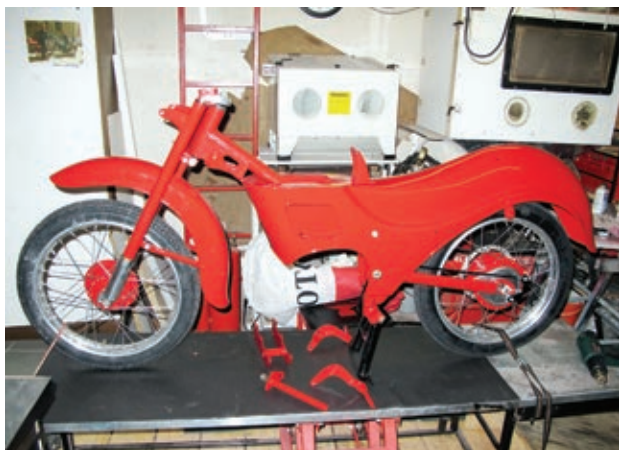
Das Fahrwerk der Zigolo ist soweit fertig.
