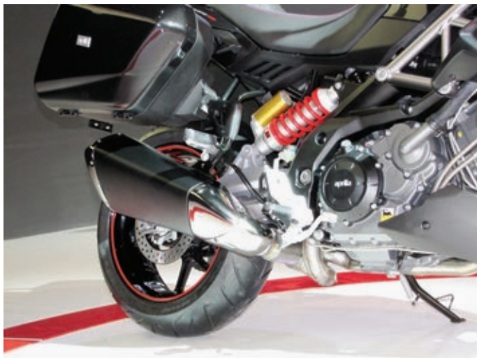
Der Schalldämpfer ist höhenverstellbar, das heißt, er ist manuell in zwei Stellungen fixierbar.
