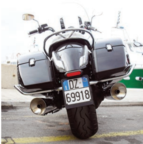
Heckansicht mit 200er-Reifen, LED-Lichteinheit und fest montierten Koffern.
