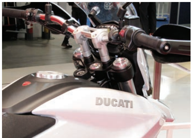
Distanzstücke heben den Lenker um 20 Millimeter an. Die Gabel ist nur bei der SP-Variante verstellbar.
