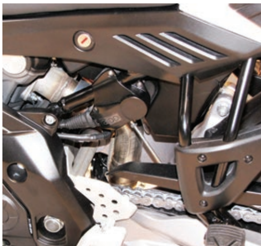
Unterhalb des Sitzbankschlusses auf der linken Seite befindet sich der Sensor für die Hinterradfederung.
