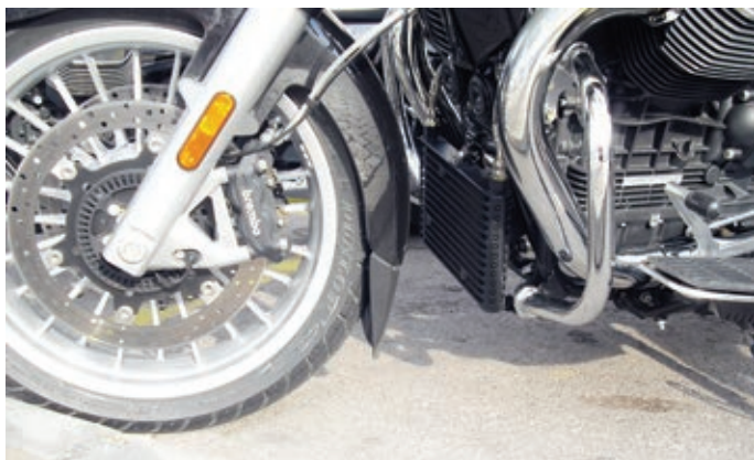
Bremsanlage wie an einem Sportbike, die Gußfelgen sind Drahtspeichenrädern nachempfunden, und die Kotflügelverlängerung schützt den Ölkühler.
