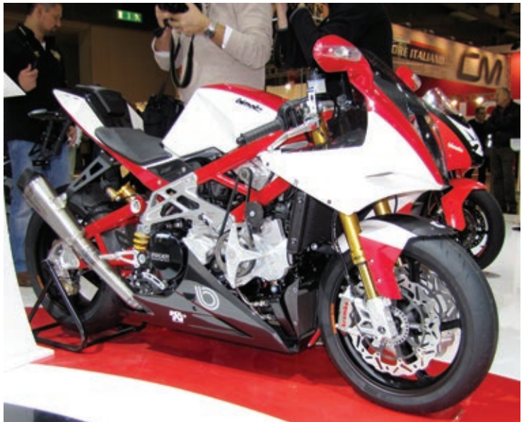
Die DB11 VLX, hier mit abgenommener Seitenverkleidung, verfügt über einen Kompressor.
