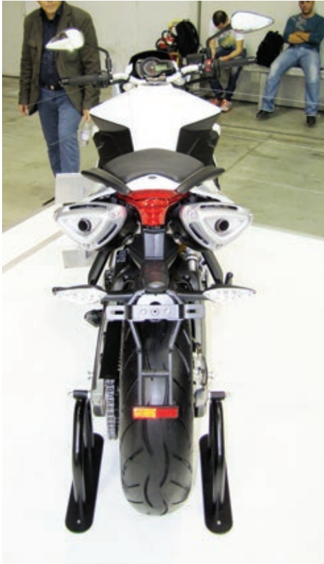
Schalldämpfer und Rücklicht erinnern genauso wie Rahmen und Stoßdämpferanordnung an die Aprilia Dorsoduro.
