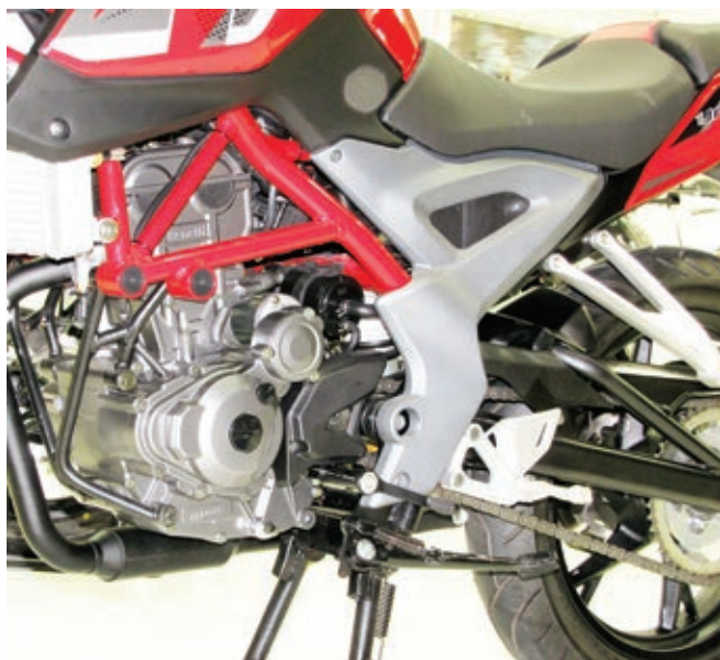
Der Hilfsrahmen vor dem Motor ist recht filigran, die Plastikabdeckung des hinteren Rahmens dafür um so größer.
