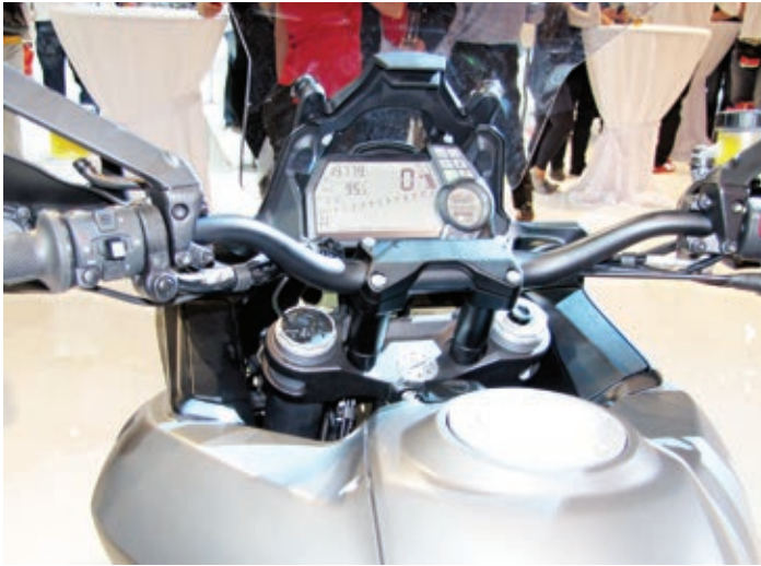
Das Cockpit bietet zahlreiche Informationen und ist gut ablesbar. Darüber ist der neue Mechanismus zur Höhenverstellung des Windschilds erkennbar.
