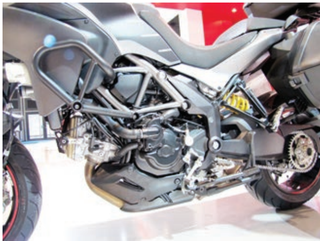
Bei den ganzen Rohren und Schläuchen fällt die zweite Zündkerze seitlich am Zylinderkopf kaum auf.
