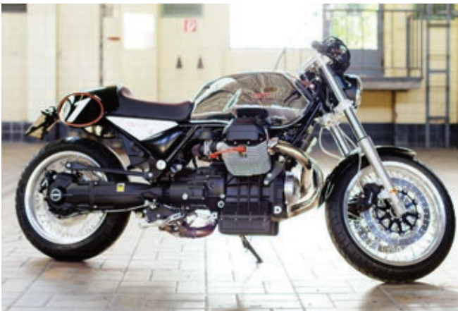
Von rechts ist ohne Auspuffanlage der komplette Antriebsstrang frei zu erkennen.
