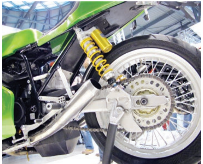
Öhlins-Federbeine, Aluminiumschwinge und klassische Speichenräder für Schlauchlosbereifung.
