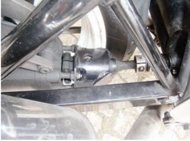
Die Kardanwelle verfügt über zwei „Freiluftkreuzgelenke“.
