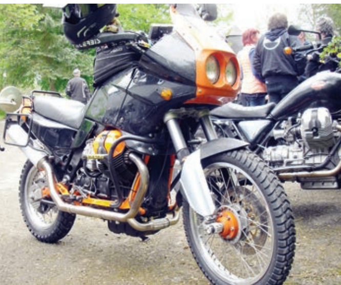
Interessanter Umbau einer Moto Guzzi Quota mit Gabel, Vorderrad und Bremsanlage aus einer KTM. Der Motor stammt aus einer Norge und wurde auf Vergaser umgerüstet.
