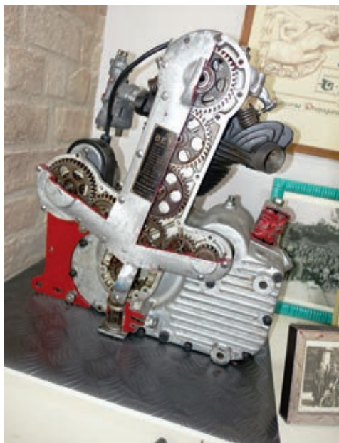
Neun Zahnräder treiben Nockenwelle, Zündung, Lichtmaschine und Ölpumpe an.
