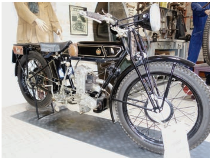
Der erste Viertaktmotor leistete mit 172 Kubikzentimetern etwa 6 PS.
