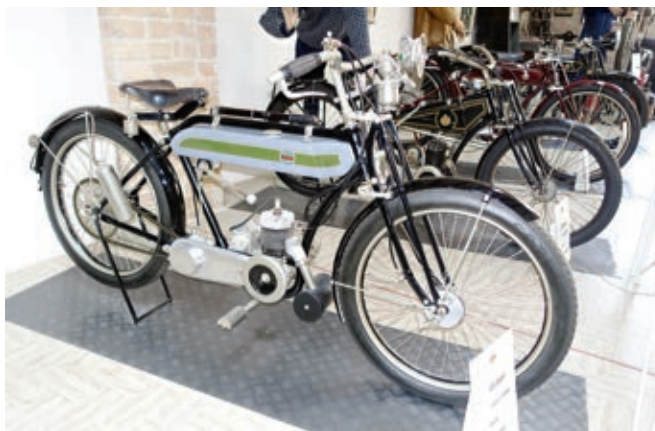
Benelli 125 Sport von 1925 mit Vorderradbremse und handgeschaltetem Zweiganggetriebe. Die Höchstgeschwindigkeit soll etwa 55 km/h betragen haben.
