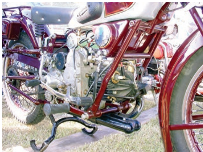
Die G.T.S. 500 ist eine Kombination der Sport 15 und der G.T. mit einem stark überarbeiteten Motor mit Viergang-Getriebe.
