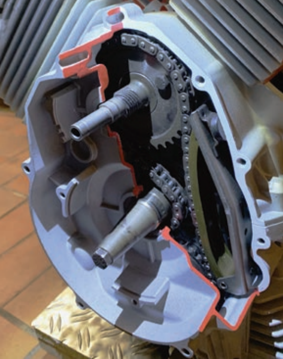
Die Steuerkette verbindet u. a. die Kurbelwelle (unten) und die darüber befindliche Nockenwelle.
