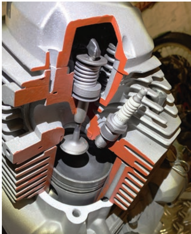
Die kleinen Guzzis haben einen Heron-Brennraum mit senkrecht stehenden Ventilen.
