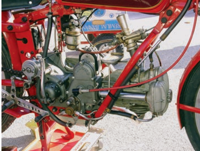
Komplett gekapselter Ventiltrieb mit einem flachen Deckel mit zentraler Handschraube.
