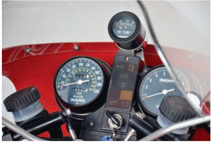
Das Cockpit mit japanischen Uhren von Nippon Denso und einem nachträglich montierten Zusatzinstrument für die Öltemperatur.
