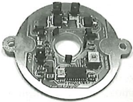
Marelli-Zündmodul ohne Blackbox aber mit LED's, Schalter und Sicherung
