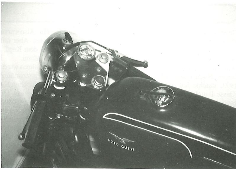
*Nach einem Unfall wurde die originale Lampe, in der der Tacho sitzt, gegen eine von Maičo ausgetauscht, passend dazu die Gabelbrücke verchromt. Hübsch ist der Schnapp-Tankverschluß im V7-Stil.*
