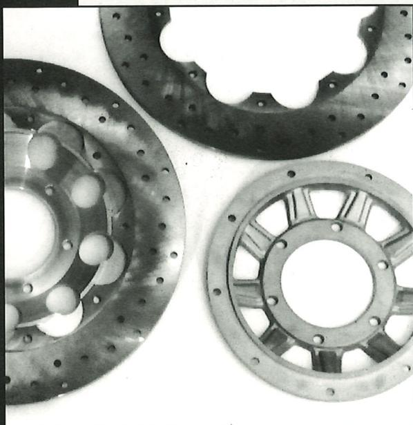
Die aus hochlegiertem Stahl gefertigten Brems-scheiben und Bremsscheibenaußenringe sind abso-lut korrosionsbeständig. Da es sich um ein beson-ders zähes Material handelt, kann keine Rißbildung wie bei normalen Gußscheiben entstehen. Die be-sonderen Eigenschaften sind:
