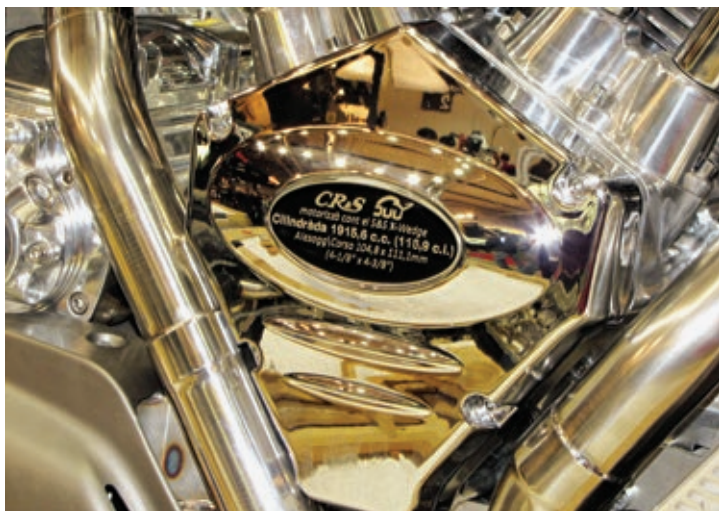
Unter diesem Deckel mit der schönen Plakette verbirgt sich der Nockenwellenantrieb.
