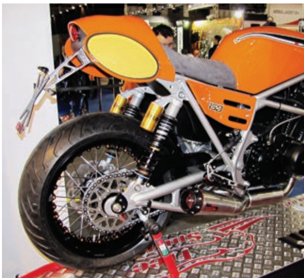
Öhlins-Federbeine, Speichenräder für Schlauchlosbereifung und exzentrisch verstellbare Fußrasten zeugen von einer guten Ausstattung.
