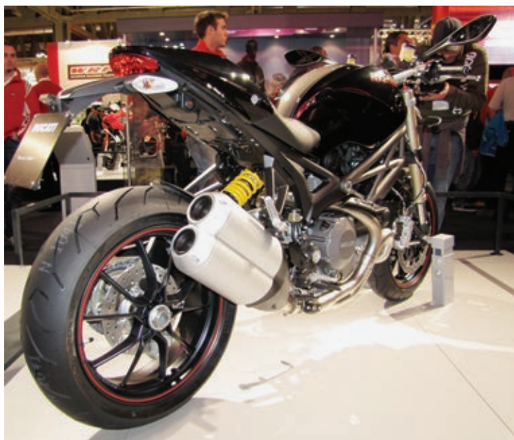
Die neue Auspuffanlage mit dem tiefen Doppelschalldämpfer verlegt den Schwerpunkt nach unten.
