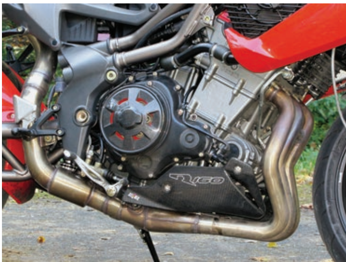
Die TNT R 160 verfügt über eine Trockenkupplung mit offenem Carbondeckel. Die Auspuffanlage führt einmal um den Motor herum.
