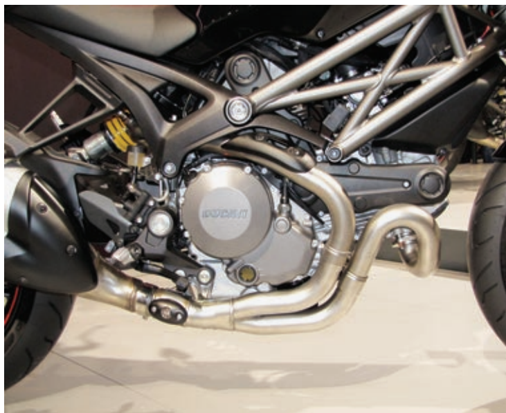
Geschwungene Krümmeranlage mit einer Drosselklappe im Auspuff unterhalb des Schalthebels.
