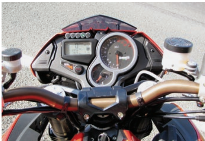
Unter dem LCD-Display befindet sich der „Powerknopf“ zum Wechseln der Kennfelder.
