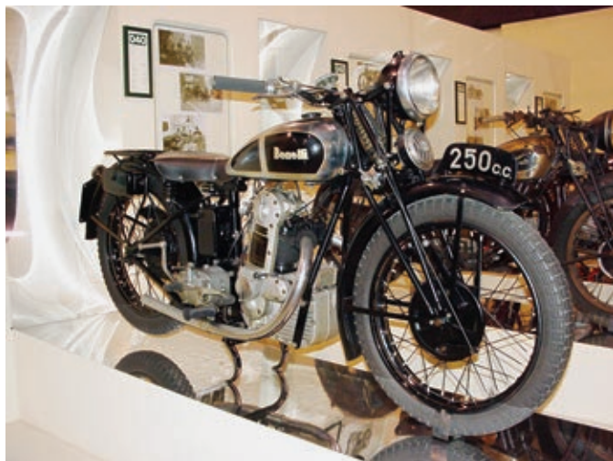
Diese Benelli 250 hat bereits ein Getriebe mit Fußschaltung aber noch keine Hinterradfederung. Zwischen den Krümmern sitzt ein kleiner Ölkühler.
