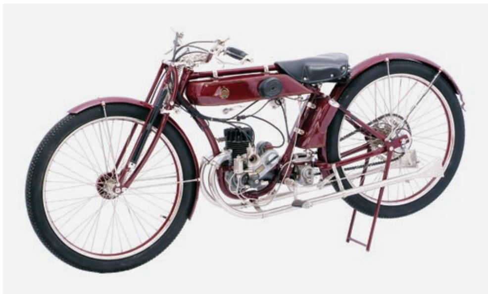
Aus dem Jahr 1925 stammt diese Benelli 147 Sport mit Doppelrohr-Auspuffanlage und separatem Öltank.
