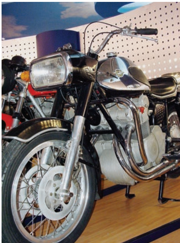
Das erste Vierzylinder-Motorrad von MV Agusta fand nur wenige Käufer und ist heute eine gesuchte Rarität. Besonders interessant ist die mechanische Doppelscheibenbremse vorne.
