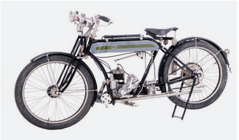
Benelli 125 von 1922. Der kleine Zweitakter verfügt über eine Magnetzündung. Das separate Getriebe hat zwei Gänge.
