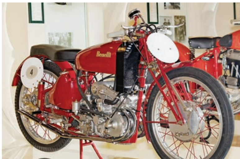
Benelli baute lange vor Honda das erste 250er-Vierzylinder-Rennmotorrad. Mit zwei obenliegenden Nockenwellen, Flüssigkeitskühlung und Kompressoraufladung war die Maschine eine absolute Sensation.
