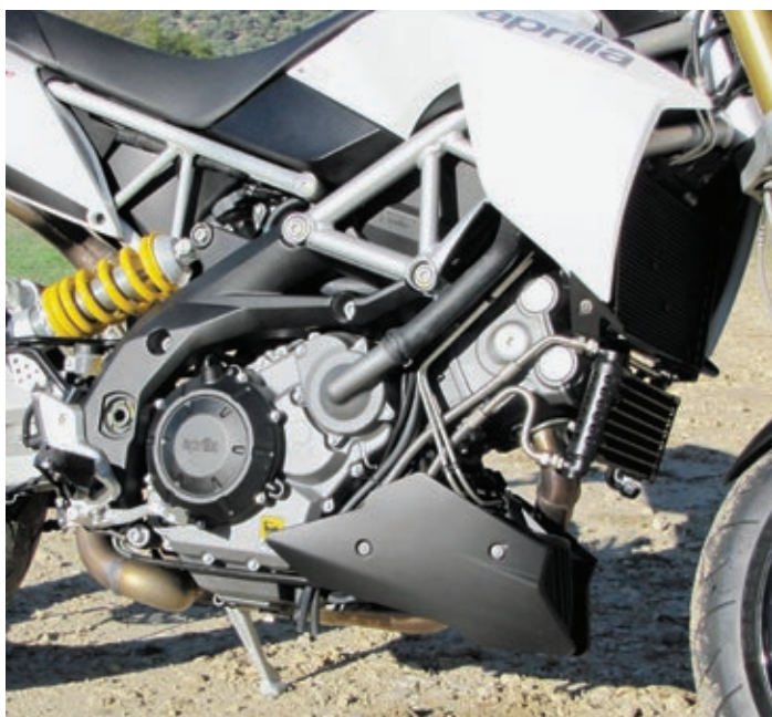
Bei dem 1.200er-Motor sitzt unter dem Wasserkühler noch ein Wärmetauscher für den Ölkreislauf.
