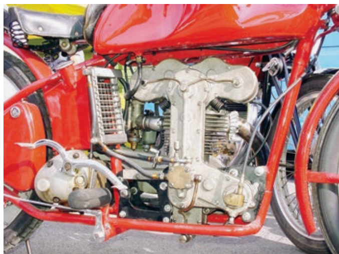
Die Rennmaschinen erhielten später neue Zylinderköpfe mit zwei Nockenwellen. Vor dem Öltank befindet sich ein Ölkühler.
