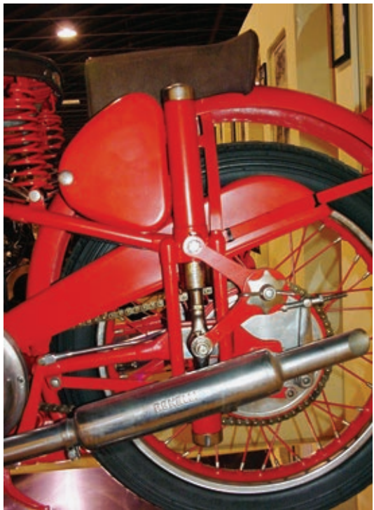
Die Hinterradfederung mit Schwinge, senkrechten, gekapselten Federn und den Scherenreißdämpfern ließ sich Benelli patentieren.
