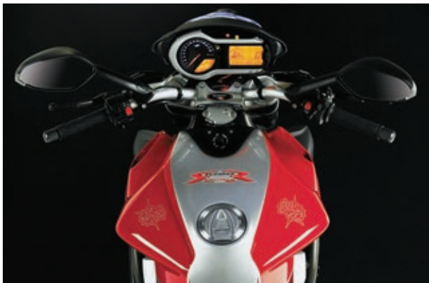
Entspannter Arbeitsplatz, mit breitem, konifiziertem Lenker, großen Spiegeln und übersichtlichem Cockpit.
