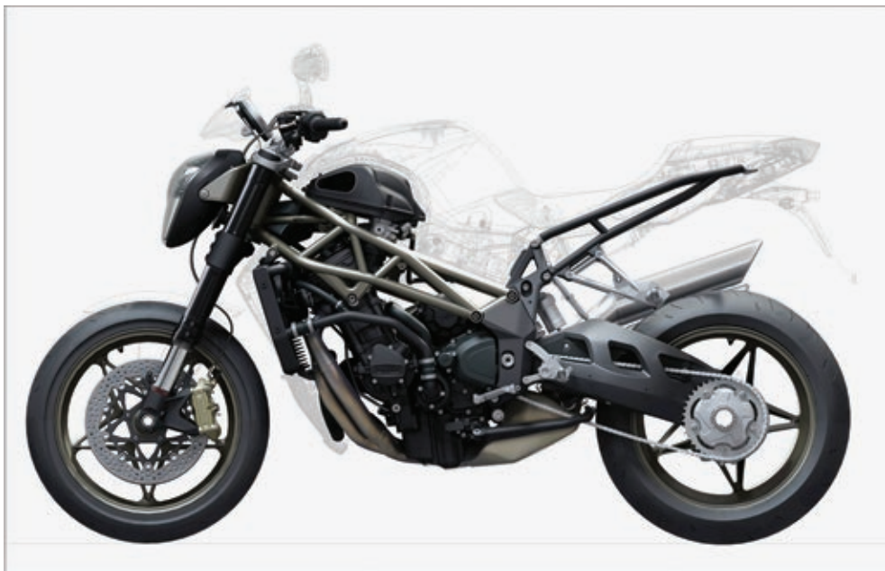
Die schöne Grafik ermöglicht einen Blick unter das Plastikkleid. Der Rahmen ist eine Verbundkonstruktion aus Stahlrohren und Aluminiumgußteilen.
