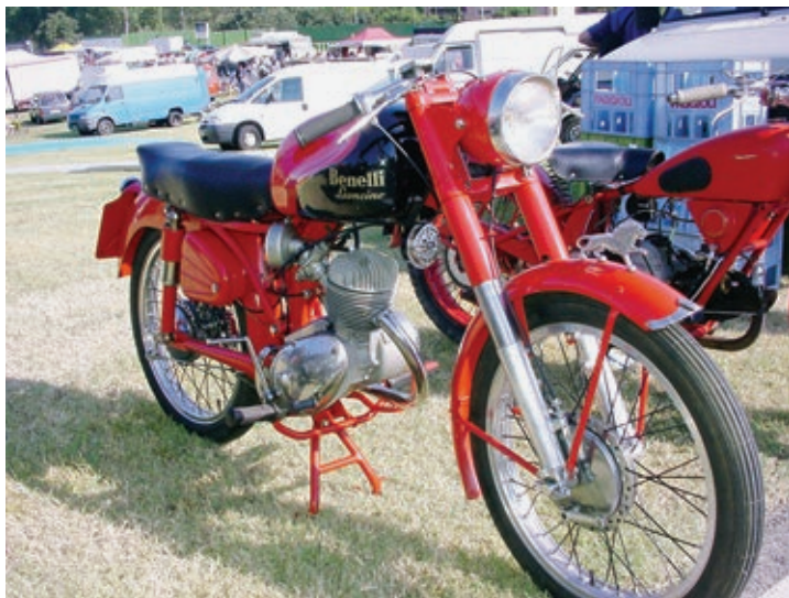
Eine spätere Version der Benelli Leoncino mit stabilerer Telegabel, zwei Stoßdämpfern hinten und langer Sitzbank.
