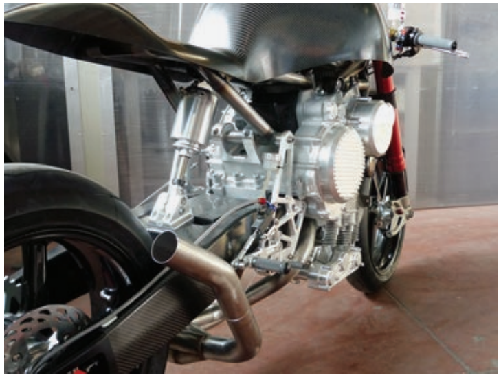
Die lange Carbonschwinge ist direkt im Motorgehäuse gelagert. Das Luftfederbein verbindet Schwinge und Heckrahmen direkt miteinander.
