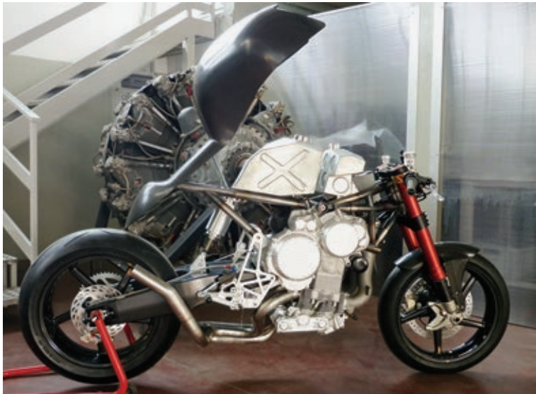
Unter dem hochklappbaren Monocoque befinden sich die Aluminiumtanks für Öl und Benzin.
