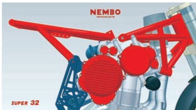
Der eigentliche Rahmen besteht aus zwei Teilen, die nicht miteinander verbunden sind.
