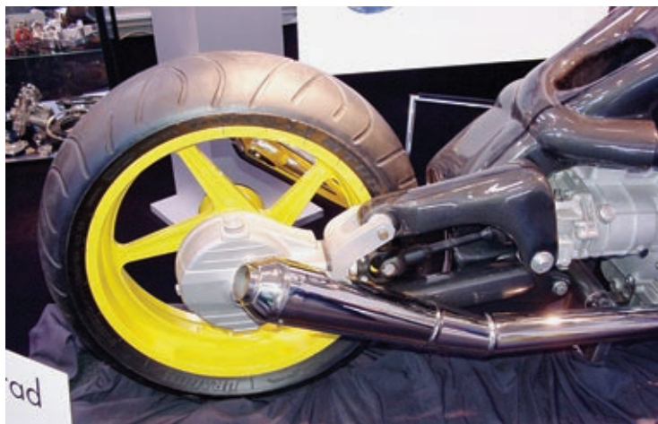
Ein besonderes Highlight war die Hinterradführung als einseitige Parallelogrammschwinge mit offen laufender Kardanwelle. Die Konstruktion sollte die Lastwechselreaktionen des Endantriebs auf ein Minimum reduzieren.
