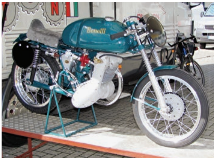
Bei der seltenen Viertakt-Benelli treiben unter dem rechten Motordeckel vier Zahnräder die Nockenwelle an.
