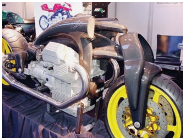
Auch die Hossack-Gabel mit den zwei Längslenkern ist komplett aus Carbon gefertigt.
