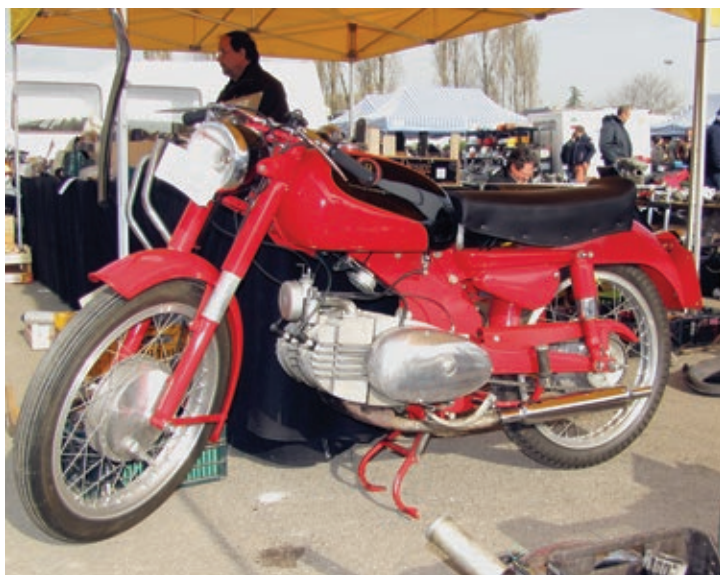
Motobi Spring Lasting mit Zweitakt-Zweizylinder-Motor mit ungefähr 10 PS.
