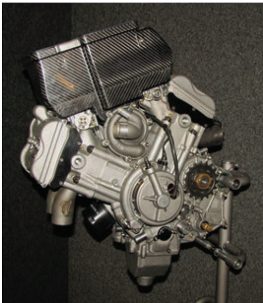
Der V4-Motor der Desmosedici aus MotoGP.
