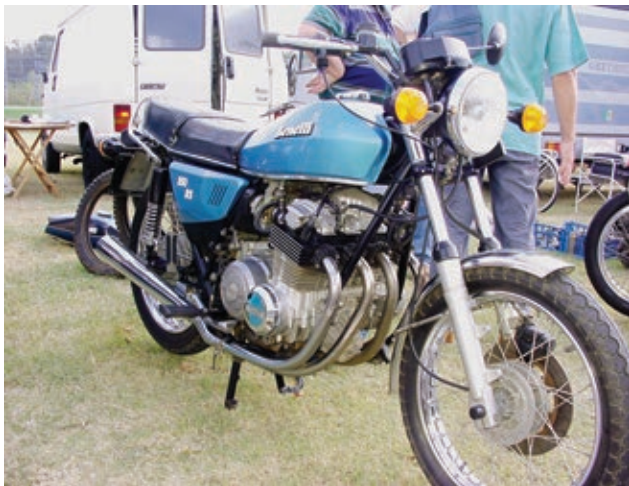
Mit neuem Styling, leichter Auspuffanlage und Scheibnbremse wurde aus der Moto Guzzi GTS 350 die Benelli 350 RS.
