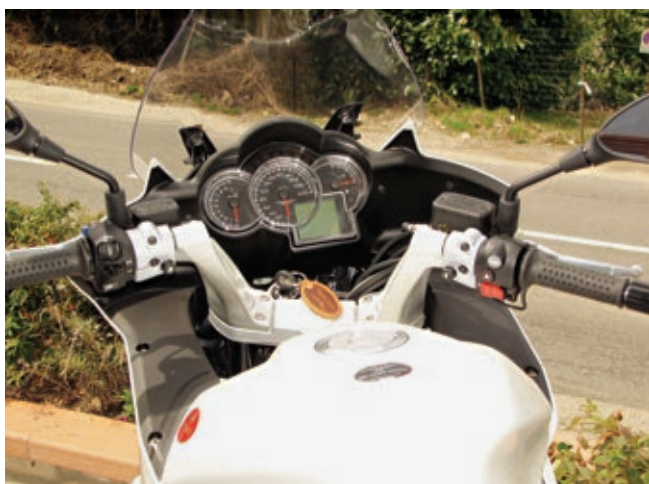
Das übersichtliche Cockpit besteht aus analogen Rundinstrumenten und einem rechteckigen LCD-Display.
