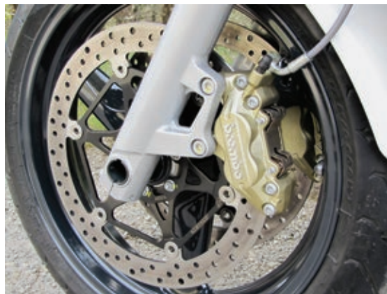
Die vordere Bremsanlage ist ein Mix aus Brembo-Sätteln und Grimeca-Scheiben.
