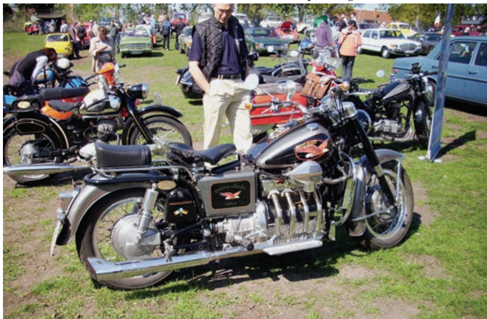
Der Vergaser und die Auspuffanlage befinden sich auf der rechten Motorseite. Der Endantrieb der Guzzi mit Kardanwelle wurde beibehalten.
