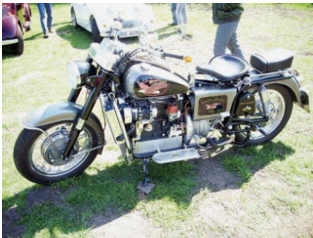
Der längs eingebaute Reihenmotor und das BMW-Getriebe passen gut in den Umbau.
