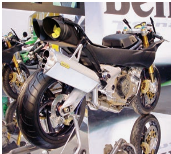
Unter dem Plastikkleid verstecken sich lange Luftkanäle zum unter der Sitzbank befindlichen Kühler.
