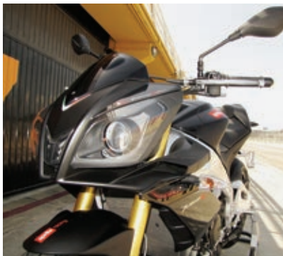
Aerodynamische Verkleidung mit seitlichen Lufteinlässen.
