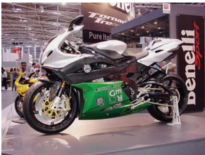
Außergewöhnliches Einzelstück - eine Tornado mit Carbonrahmen.
