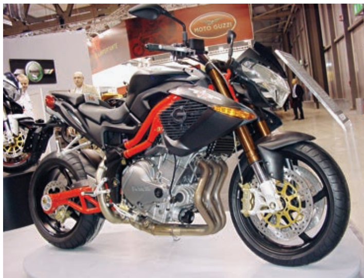
Die TNT Sport verfügt im Gegensatz zum Basismodell über radiale Bremssättel.
