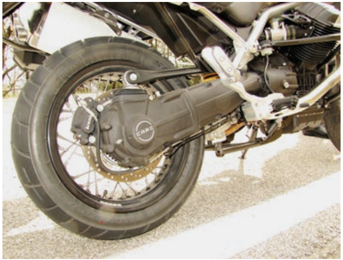
Die Einarmschwinge mit Momentabstützung für den Kardantrieb arbeitet tadellos. An der Stelvio NTX sind Drahtspeichenräder anstelle der Gußfelgen verbaut.
