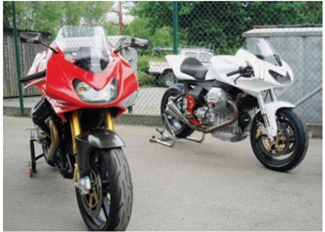
Original und Fälschung: Links eine MGS/01 die nachträglich für den Straßenverkehr umgebaut wurde, und rechts eine MGS/01-Replica für die Rennstrecke auf Basis einer V11.
