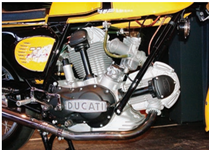
Bei der 750 Sport waren Motorseitendeckel und der Königswellenantrieb schwarz lackiert, was einen schönen Kontrast ergab. Wegen des elektronischen Drehzahlmessers entfiel der Wellenantrieb auf dem vorderen Königswellendeckel.
