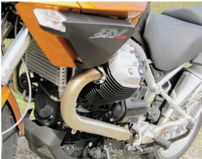
Ein großer Ölkühler zwischen den Zylindern sorgt dafür, daß dem Motor nicht zu heiß wird.
