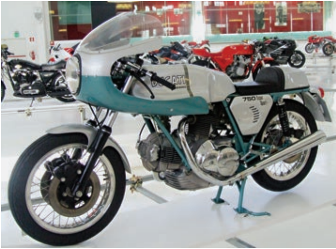
Der Traum fast aller Ducati-Fans, die legendäre 750 SS Rundmotor mit Halbschale, Desmodromik und drei Brems-scheiben. Die Bremssättel befinden sich hier vor der Gabel.
