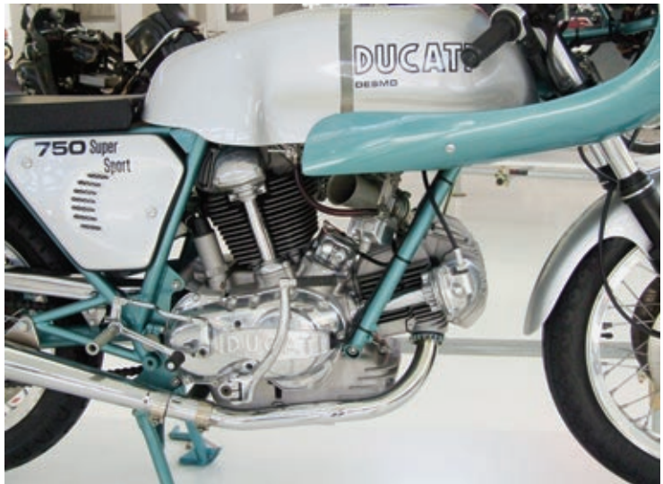
Der Sichtstreifen im Kunststofftank zeigt den Benzinstand an. Im Gegensatz zur 750 Sport verfügt die 750 SS wieder über einen mechanischen Drehzahlmesserantrieb, der jetzt aber im Königswellendeckel integriert ist.
