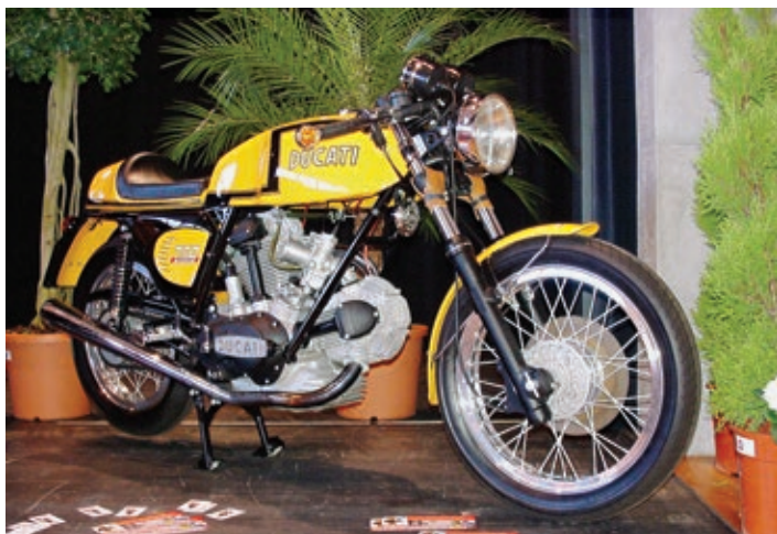
Aus der 750 GT entstand bald die 750 Sport, bei der die Vergaser frei durchatmen durften.
