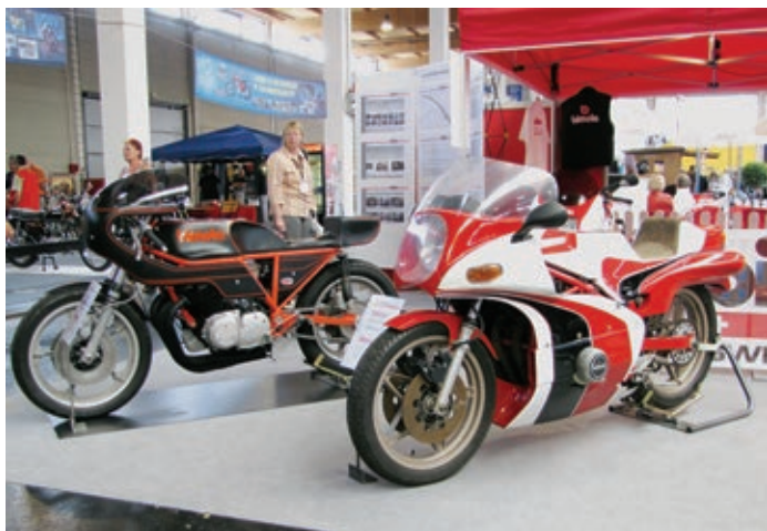
Mit der Bimota HB1 nahm die Geschichte der Straßenmotorräder aus Rimini ihren Anfang. Ein Meilenstein in der Bimota-Historie ist die SB2 mit teilbarem Rahmen und koaxialer Schwingenlagerung.
