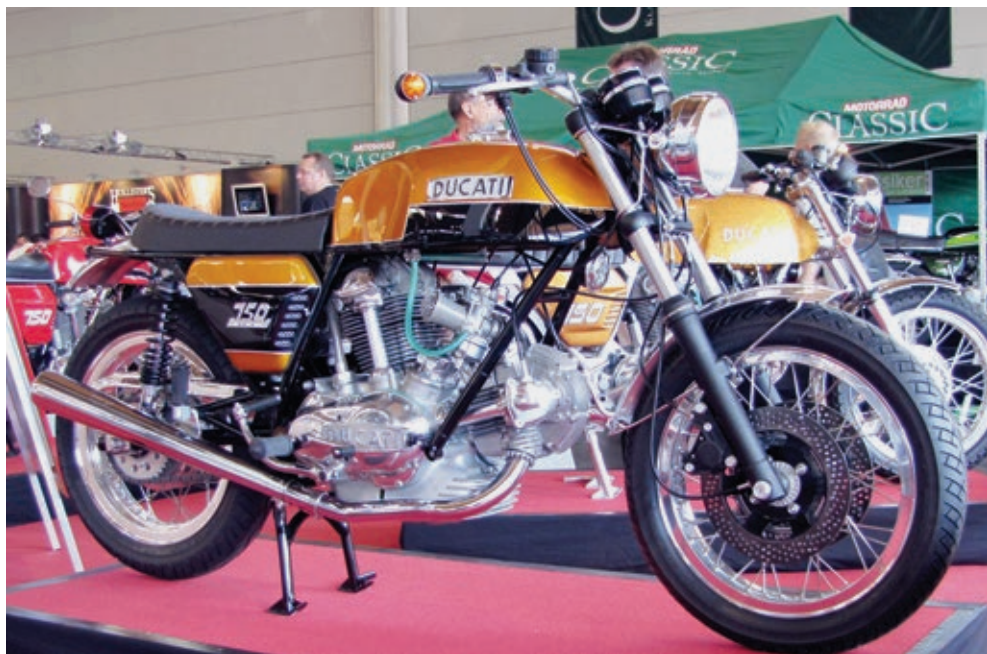
Eine der späten 750er GTs mit Brembo-Bremssattel und gabelmittig platzierter Vorderradachse.
