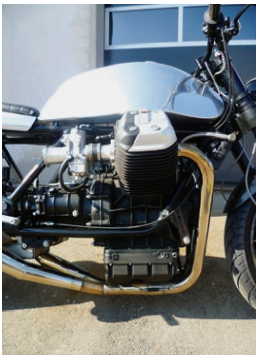
Mit ein paar Umbauten paßt auch der aktuelle Vierventil-Motor in den Tonti-Rahmen.
