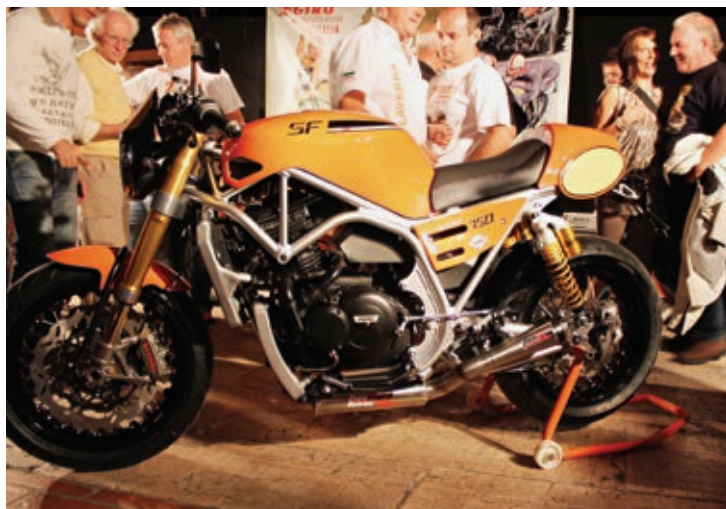
Im Vergleich zum Prototypen der Breganze 750 SF wurde noch einiges geändert. Der Rahmen ist nun aus Aluminium, die Gabel stammt von Öhlins und das Serienmodell verfügt jetzt über Brembo-Bremsen.
