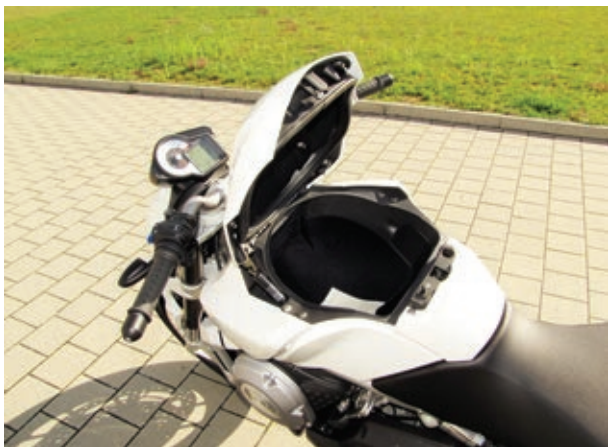
Der Kupplungshebel fehlt, dafür befindet sich in der Tankattrappe ein großes Staufach.
