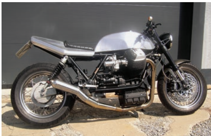
Aktuelles Projekt ist der Vierventil-Motor im Tonti-Rahmen.
