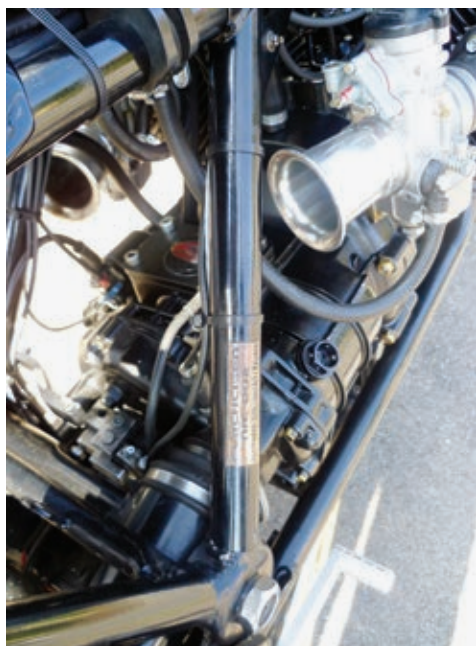
Mit den alten Rahmen ist es möglich, offene Vergaser zu verwenden.
