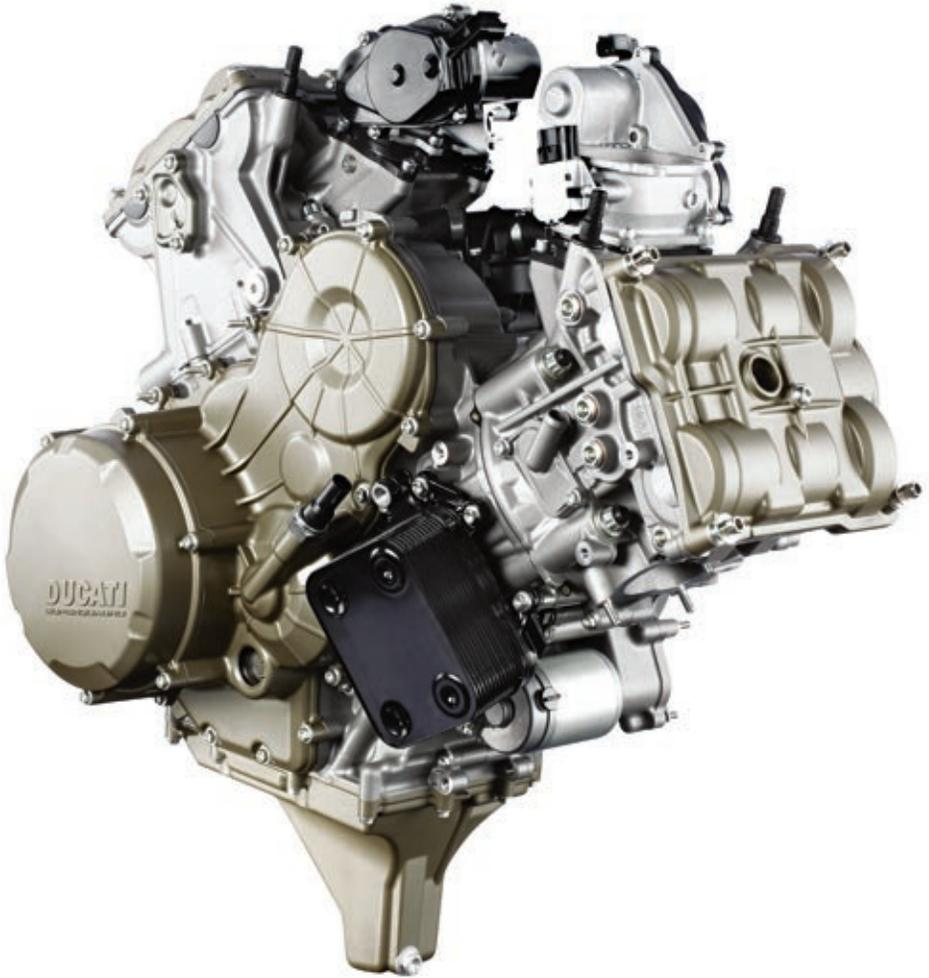
***Die Ölwanne führt weit herunter, um in allen Fahrsituationen eine optimale Schmierstoffversorgung sicherzustellen. Bei dem schwarzen Anbauteil handelt es sich um einen Öl-Wasser-Wärmeaustauscher.***
