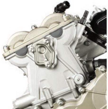
**Die Zylinderköpfe sind nicht identisch, wie man gut an den Steuerkettenspannern erkennen kann. Beim vorderen Zylinder befindet sich der Spanner auf der Einlaßseite, beim hinteren ist der Mechanismus auf der Auslaßseite zu entdecken.**
