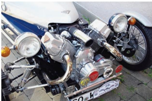
*Viele Threewheeler werden von großen Moto Guzzi-Motoren angetrieben.*
