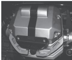
Die Bügel sind CNC gefräst aus 8 mm Alu und stahlkugelpoliert. Sie werden zwischen Ventildeckel und Zylinderkopf montiert, sind dadurch äußerst stabil und schützen Zylinder und vor allem die Zündkerze. Das Komplettsset mit 4 Dichtungen und passenden VA-Schrauben kostet zum Einführungspreis 139,- €. Info unter: [meinolf.schulte@gmx.de](mailto:meinolf.schulte@gmx.de) oder 0171 3546461
