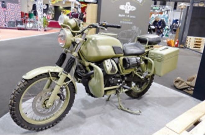
Moto Guzzi V7 im Militärlook und mit geländegängiger Bereifung. Die Doppelrohrauspuffanlage stammt von der Firma Arrow. Stabile Sturzbügel und Beinschilder schützen Fahrer und Maschine.
