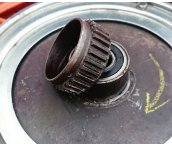
Die Mitnehmerversatzung am Hinterrad ist abgeschert.
