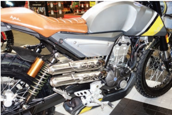
Schräg von hinten kann man den Vorschalldämpfer im Motorkeil erkennen. Von dort führt ein Rohr zu den beiden verchromten Endschalldämpfern.
