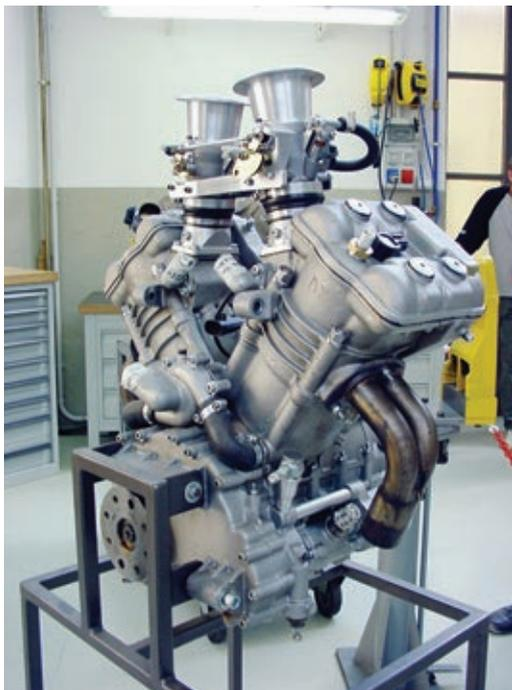
*Zwei obenliegende Nockenwellen, vier Ventile, Fallstromansaugung und Flüssigkeitskühlung waren bereits damals realisiert.*
