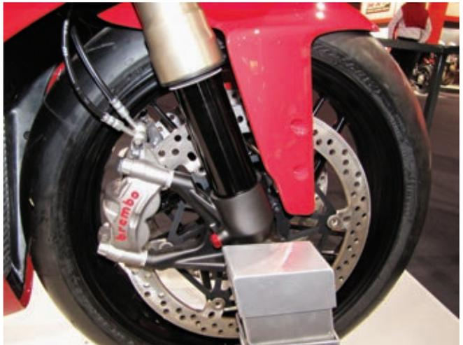
*Die leichte Aluminiumgabel von Marzocchi mit Gleitrohrbeschichtung und neue Bremssättel sparen Gewicht.*
