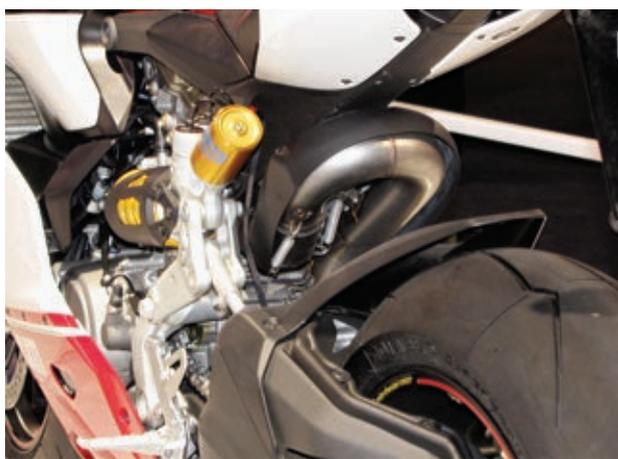
**Wegen des nach hinten gekippten Motors und der neuen Krümmerführung versetzten die Entwickler das Federbein auf die linke Fahrzeugseite.**
