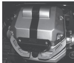
Die Bügel sind CNC gefräst aus 8 mm Alu und stahlkugelpoliert.
