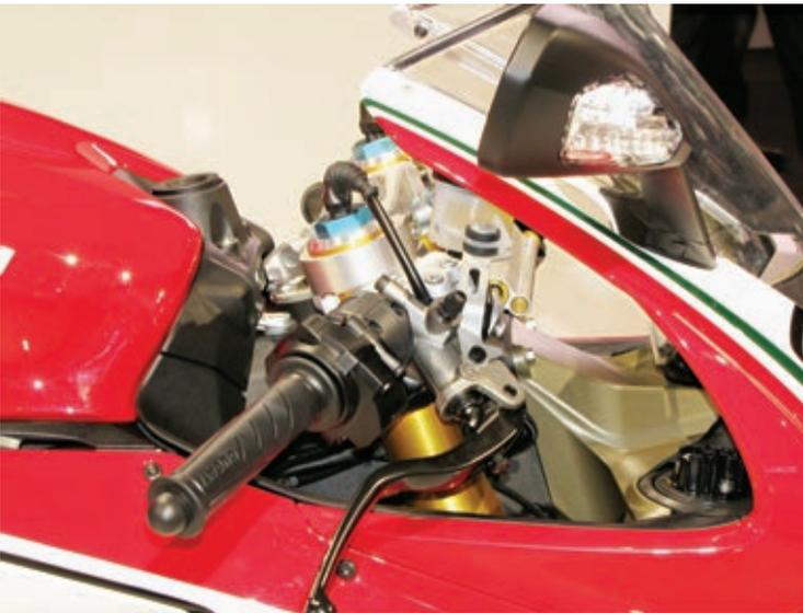
***Radiale Handpumpen, gefräste Gabelbrücke, Lenkungs-dämpfer quer vor der Gabelbrücke und bei der S ein elek-tronisches Fahrwerk ... Herz, was willst Du mehr?***
