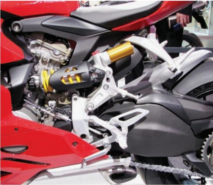
*Das Federbein und seine Verstellerschrauben sind gut zugänglich. Zwei unterschiedliche Verschraubungspunkte beeinflussen die Progression.*
