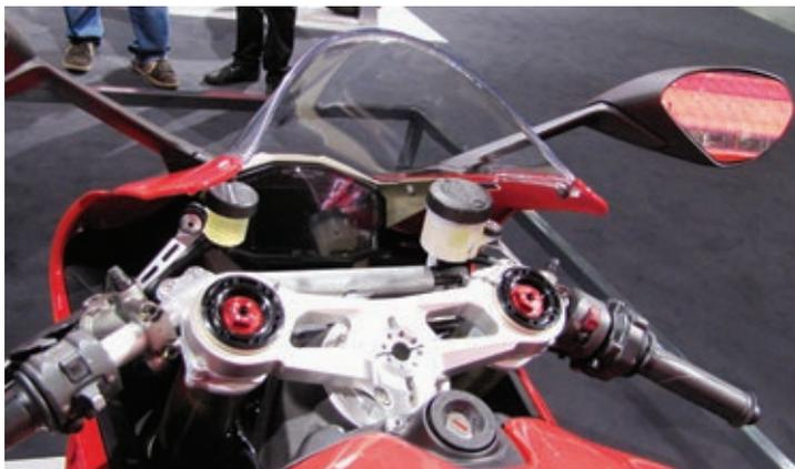
**Die vorderen Bremsflüssigkeitsbehälter sowie die abstehenden Spiegel bieten Umbaupotential.**
