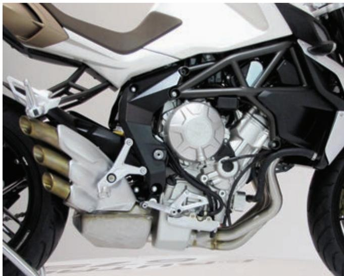
*Der Drilling im eingebauten Zustand. Charakteristisch für die kleinen Modelle ist die Auspuffanlage mit drei Stummelrohren.*
