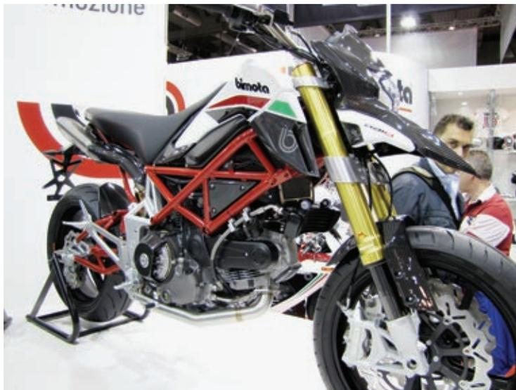
***Bei der DB 10 B.Motard sind Rahmen und Schwinge Verbundkonstruktionen aus Stahlrohren und Aluminiumfrästeilen.***
