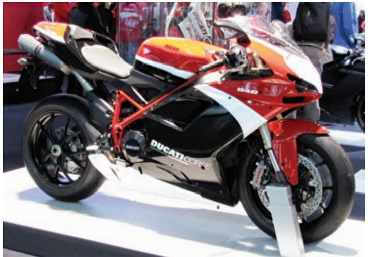
*Größere Bremsscheiben, Traktionskontrolle, Schaltautomat und ein Öhlins-Federbein sind die technischen Änderungen an der Ducati 848 Evo Corse.*
