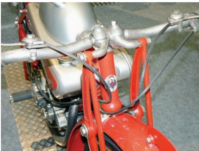
Wo hat man das schon mal gesehen? Ein in fast alle Richtungen stufenlos verstellbarer Lenker. Der Lenker besteht aus zwei Hälften, die inneren Enden sind wie Kugeln geformt und in einer Klemmvorrichtung gelagert - einfach genial und genial einfach.
