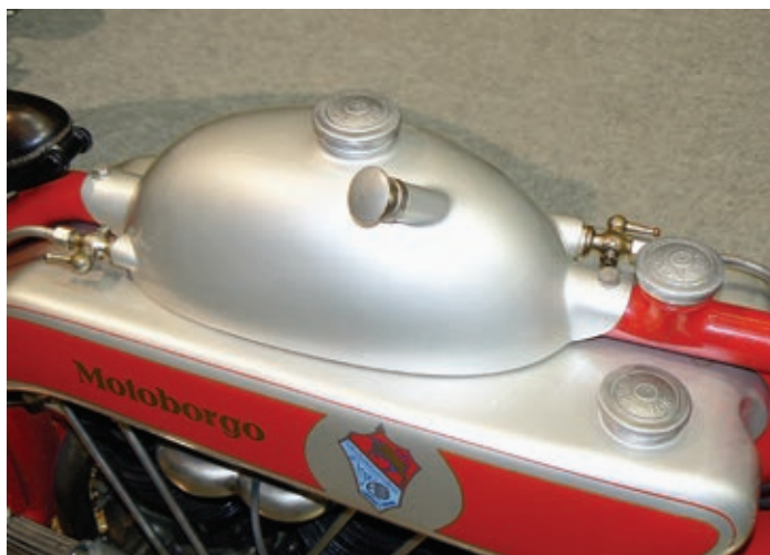
Der Benzintank hängt unter dem Rahmenhauptrohr. Darüber thront der Öltank, und auch das Rahmenrohr dient als Ölreservoir.
