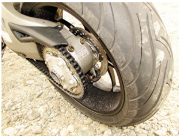
Späne auf der Hinterradfelge der MV Agusta Brutale ... da war der Fehler schnell gefunden.
