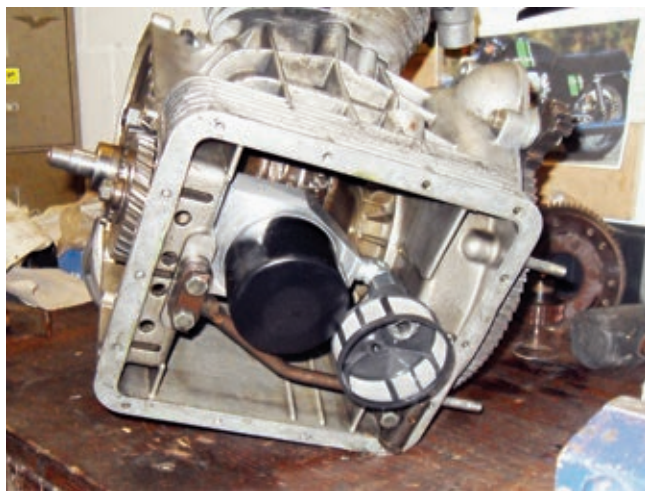
Nachträglich erhielt der Motor einen modernen Ölfilter im Hauptstrom. Eine sinnvolle Umrüstung, welche die Lebenserwartung des V2s deutlich erhöht.
