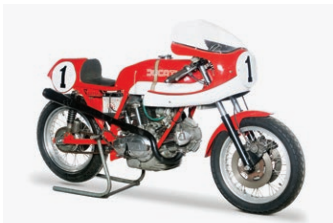
Aus der Mitte der siebziger Jahre stammt diese Ducati 750er-Rennmaschine mit Rundmotor, Scarab-Bremsanlage und hochgezogener Auspuffanlage.
