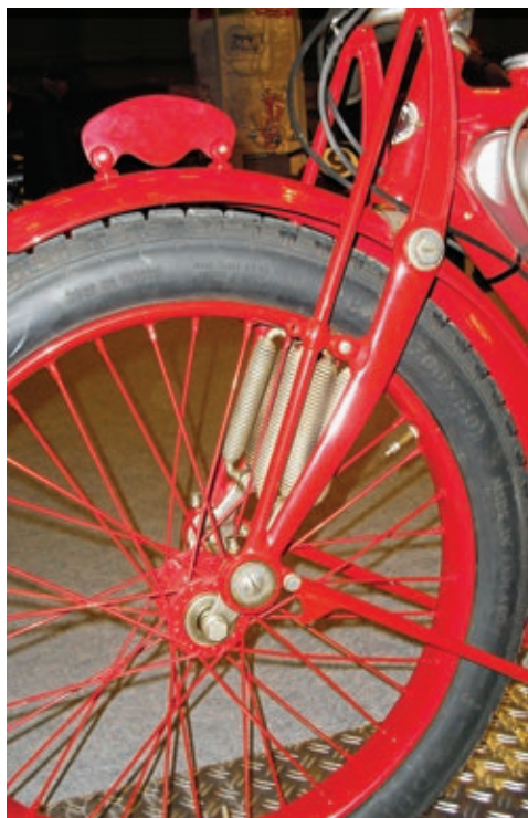
An der Innenseite der Gabel befinden sich die Federn für die Vorderradfederung.
