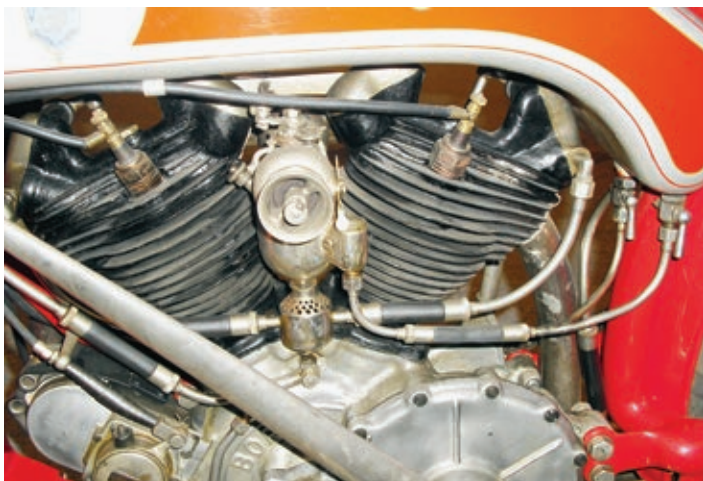
Die Gemischaufbereitung: Ein zentraler Vergaser mit Drosselklappe. Der Tank ist hinten tief hinuntergezogen, damit wirklich das komplette Volumen genutzt werden kann.
