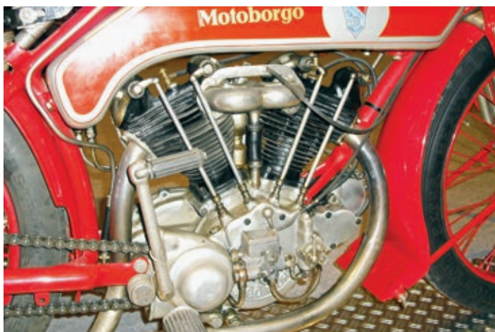
Der Blick von rechts zeigt den Ansaugstutzen, der die Gase im Bogen zu den Einlaßventilen leitet.
