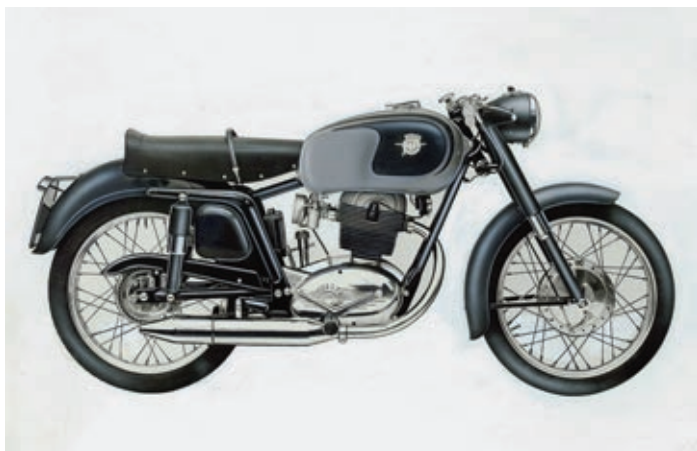
Die Tevere 235 ist sozusagen eine 175er mit dem Zylinder der Raid 250.
