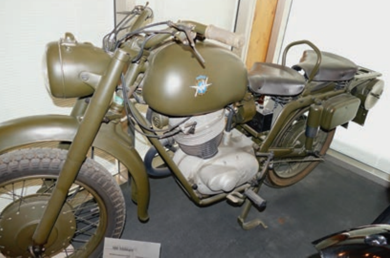
Prototyp einer Raid 300 Militär. Von diesem Rahmen wurden nur fünf Exemplare für Erprobungs- zwecke gebaut.
