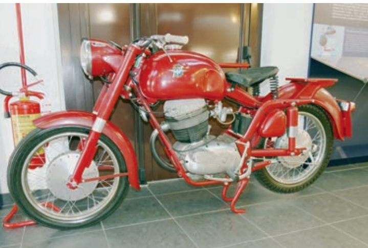
Raid 300 mit dem späteren „Militär- rahmen“: Dieser ist für mehr Stabilität unten geschlossen im Gegensatz zu den normalen Straßen- modellen mit unten offenen Rahmen.
