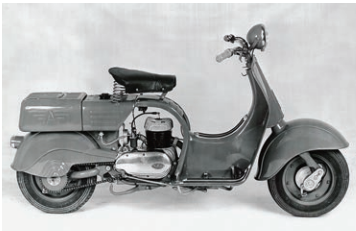
Die Version eins des CGT stammt in vielen Punkten vom Tipo A ab, hat aber einen höheren Mitteltunnel wie der CSL.
