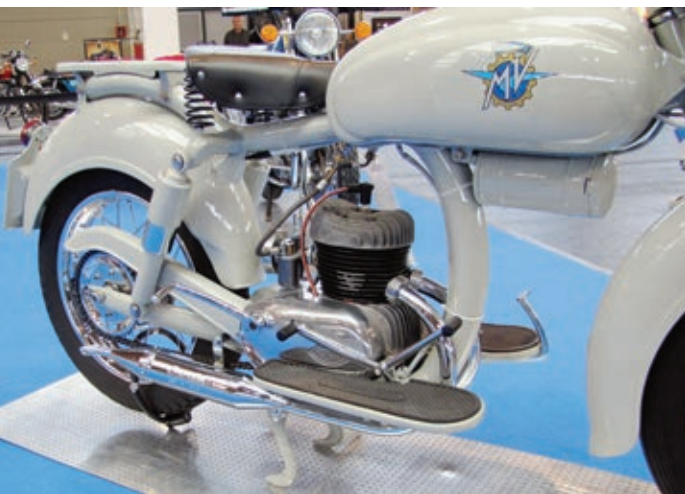
Die zweite Version des Pullmans mit Fußschaltwippe, echten Stoßdämpfern und einem geraden Ansaugstutzen.
