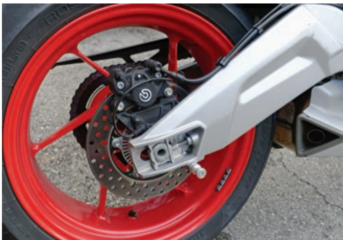
Die Bremsanlage stammt von Brembo. Hinten ist ein Zweikolbenfestsattel oberhalb der Schwinge montiert.
